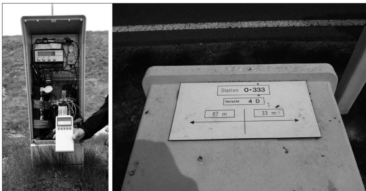
Bild 8: Wetterstation mit Datenlogger (links) und Abschnittsmarkierungen durch Beschilderung der Wetterstation (rechts)
