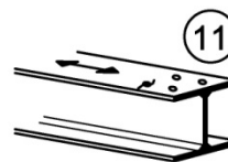
Bild 45: Detail 11 aus DIN EN 1993-1-9:2005, Tabelle 8.1
