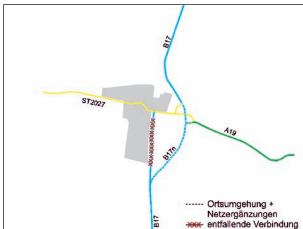
Bild 6: Netzsituation für die Ortsumgehung Klosterlechfeld (B 17) mit Markierung der bei Realisierung der Ortsumgehung eintretenden Netzveränderungen
