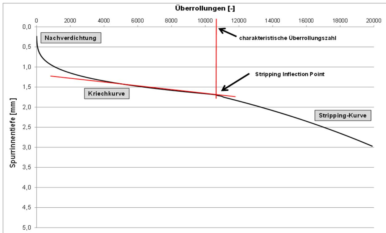
Bild 1-1: Theoretischer Spurrinnenverlauf im Stripping Test [Radenberg et al., 2016] nach [Solaimanian et al., 2003]
