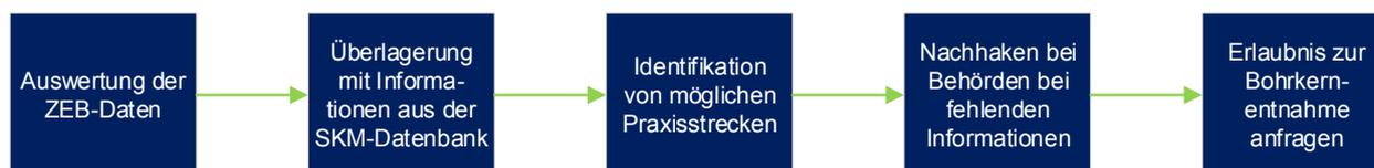
Bild 2-2: Fließdiagramm zur Vorgehensweise für die Streckenfindung
