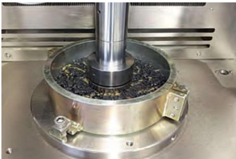
Bild 1-3: Dynamischer Stempelndringversuch mit Stützring [Wistuba; Isailović, 2018]
