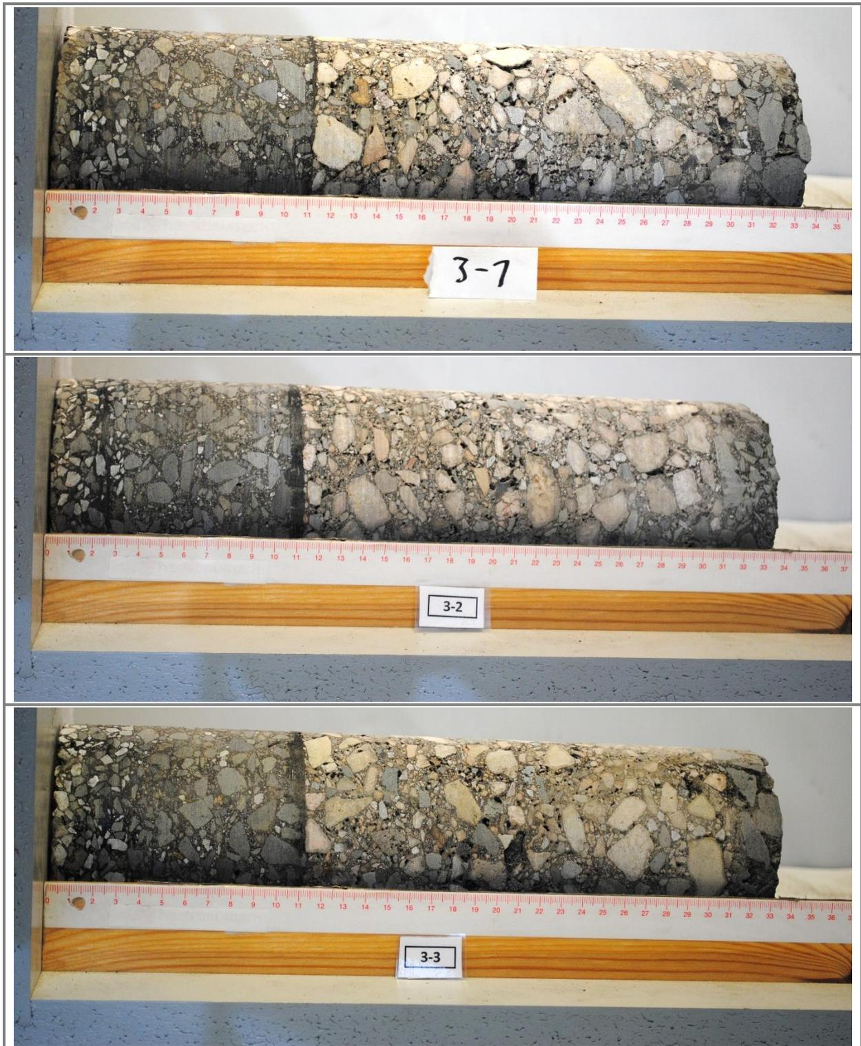
Bild A-17: Bohrkern  $\varnothing$  100 mm, Entnahmestelle 3 – B51 Olzheim
