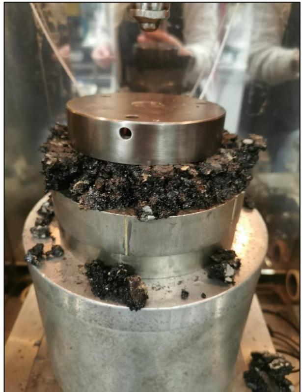
Bild A-18: Gefüge-zerstörte Probekörper - B51 Olzheim
