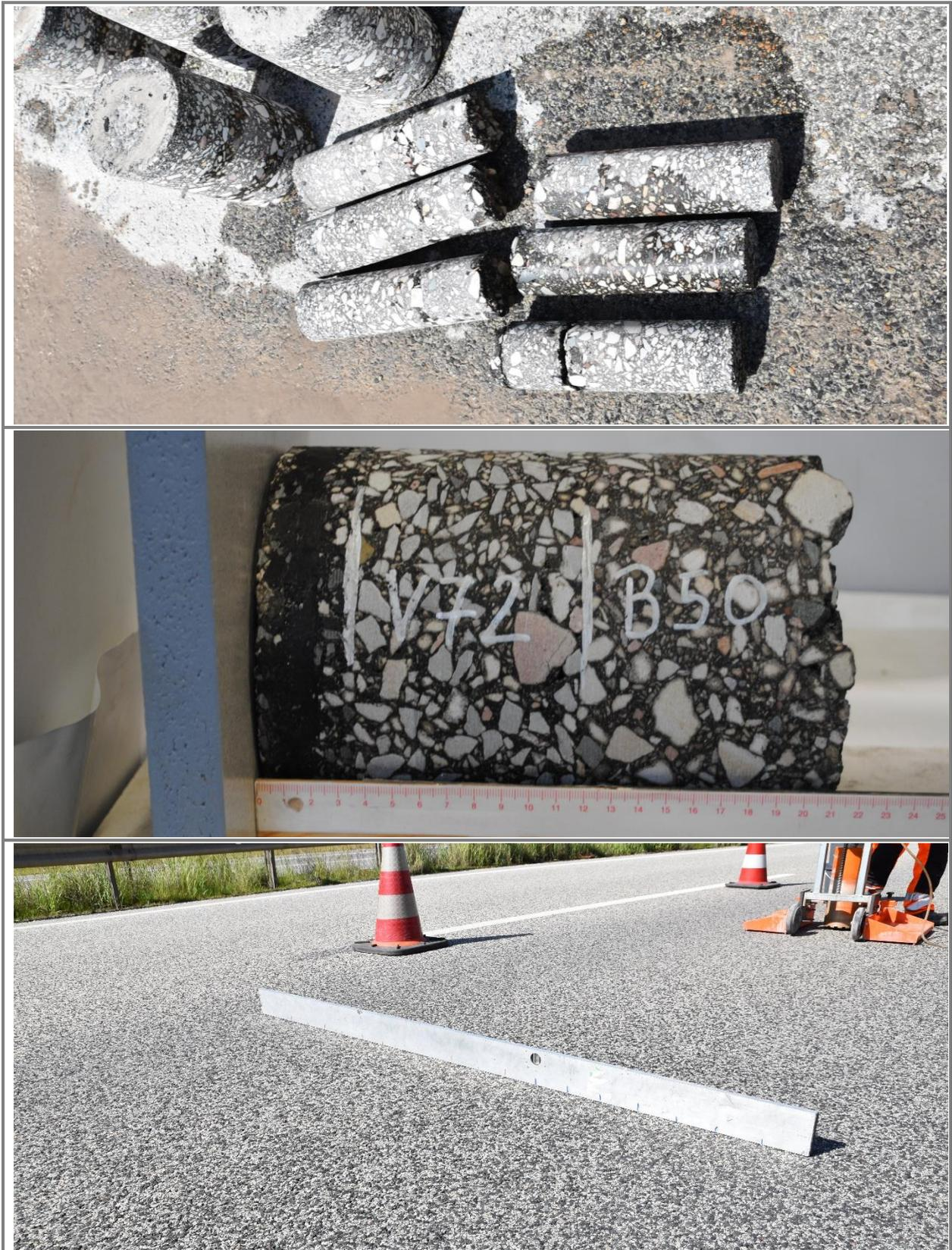
Bild A-19: Bohrkernentnahme - B50 Hunsrück
