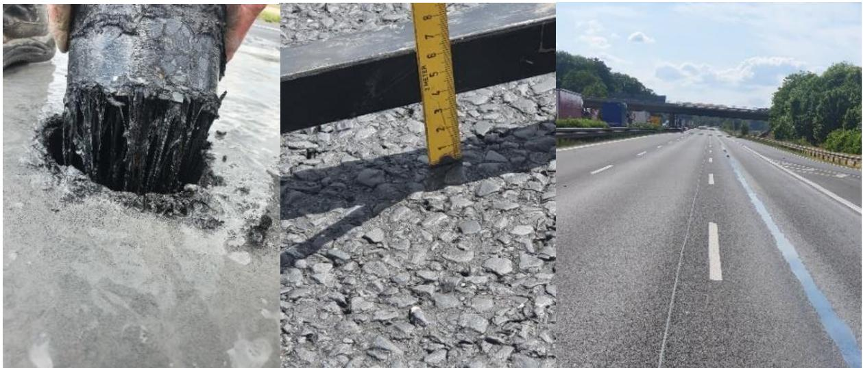
Bild 4-29: Fotos der BK-Entnahme A10, links: BK mit SAMI-Schicht, Mitte: Spurrinne, rechts: Wasser in der Spurrinne
