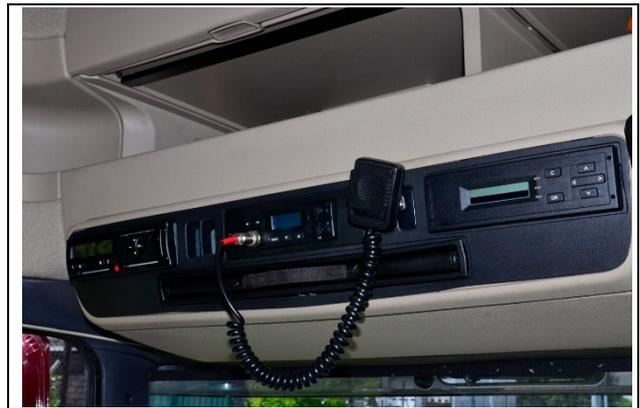
**Bild 14:** CB-Funkgerät (Quelle: <https://cdn.trans.info>)
