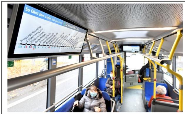
**Bild 17:** Beispiel für dynamische Haltestellenanzeigen im Fahrzeug (Quelle: www.mvg.de)
