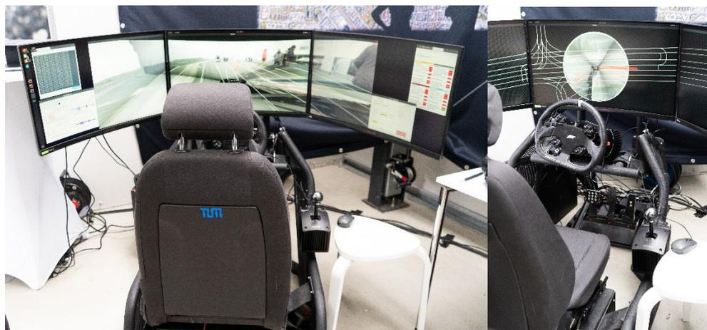
Abbildung 9: Leitstand auf dem Final Event des Projekts UNICARagil. (Bild: Lena Plum)
