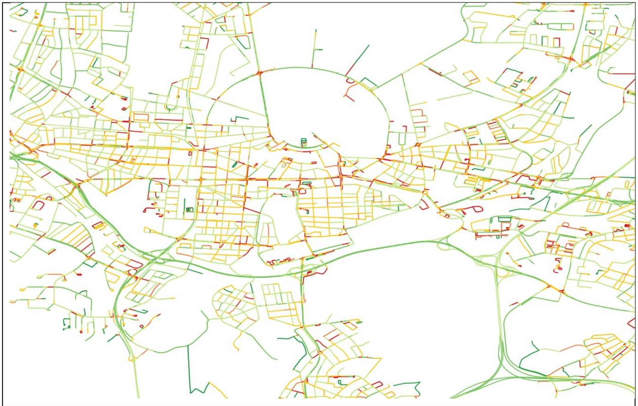
Bild 7-2: Störungsindikator aus Geschwindigkeitsverteilungen auf Linkbasis für Karlsruhe mit Berücksichtigung der zulässigen Höchstgeschwindigkeit. (grün  $SI < 1$ , gelb  $1 \leq SI < 2$ , rot  $SI \geq 2$ )
