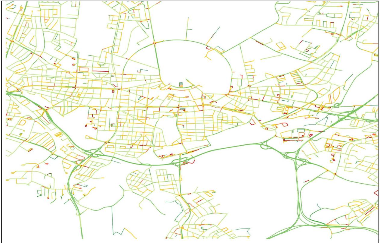
Bild 7-3: Störungsindikator aus Geschwindigkeitsverteilungen auf Linkbasis für Karlsruhe ohne Berücksichtigung der zulässigen Höchstgeschwindigkeit. (grün  $SI < 1$ , gelb  $1 \leq SI < 2$ , rot  $SI \geq 2$ )
