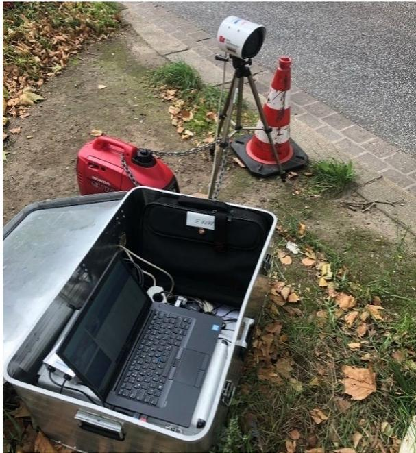
Bild 4-9: Beispiel für den Aufbau der ANPR-Messgeräte
