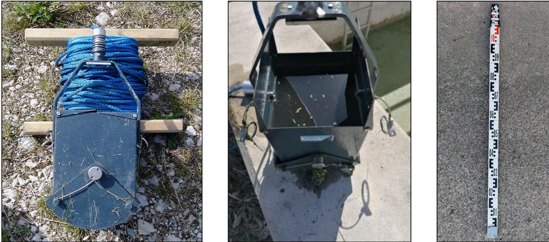
Bild 3-1: Ekman-Birge Sedimentgreifer und Peilstange
