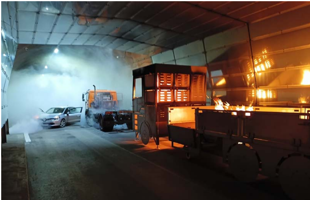
Bild 9: LKW-Mock-up, Durchfahrthindernisse PKW und LKW, Blickrichtung entgegen Fahrtrichtung
