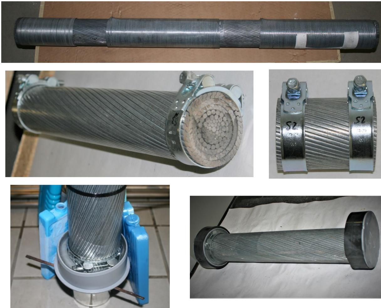
**Abb. 34:** Herstellung der Seilproben für Freibewitterungsversuche. Oben: Anlieferungszustand. Mitte links: 45 cm Abschnitt für die Freibewitterung (zunächst ohne Kunststoffkappe). Mitte rechts: 10 cm Abschnitt (Nullmuster). Unten links: Probenende beim Einbetten in EP. Unten rechts: fertiger Probekörper.
