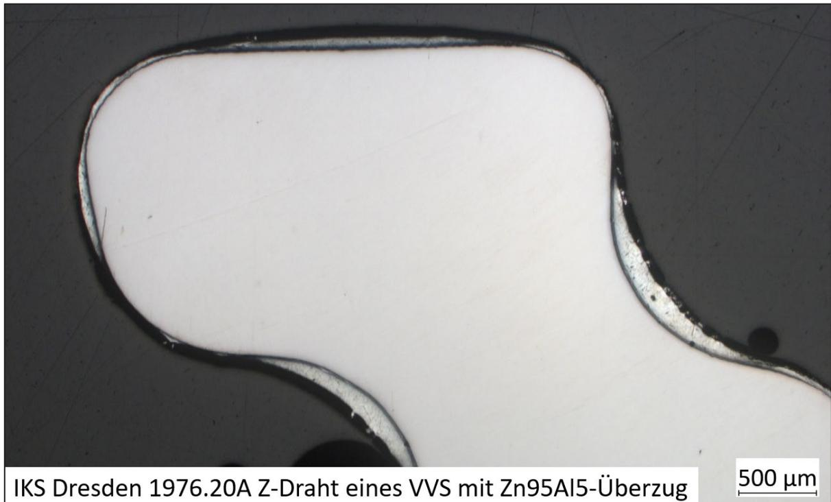
IKS Dresden 1976.20A Z-Draht eines VVS mit Zn95Al5-Überzug
