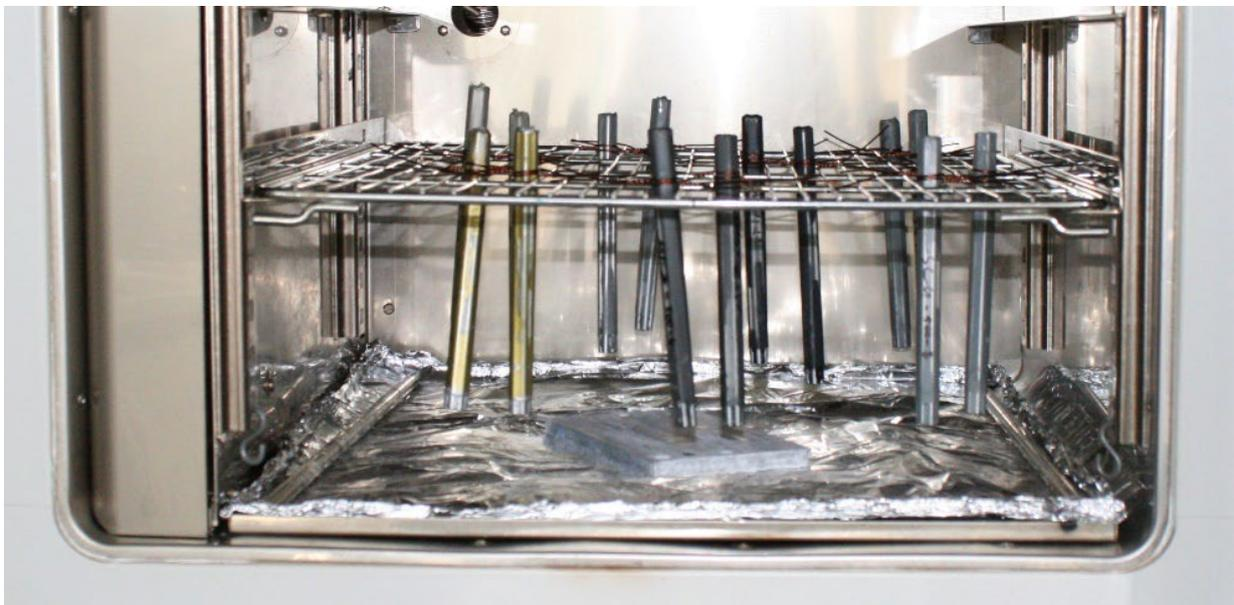
**Abb. 15:** Abtropfversuch mit Seilprobekörpern.
