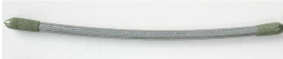
**Abb. 4:** Endseitig geschützter Abschnitt eines Seildrahtes mit Zinküberzug.
