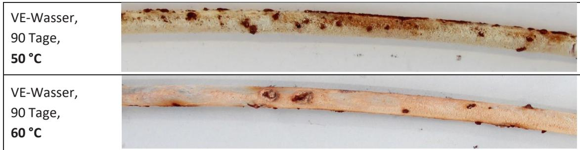
**Abb. 6:** Vergleichende photographische Aufnahmen bei 50 und 60 ° belasteter Drähte.
