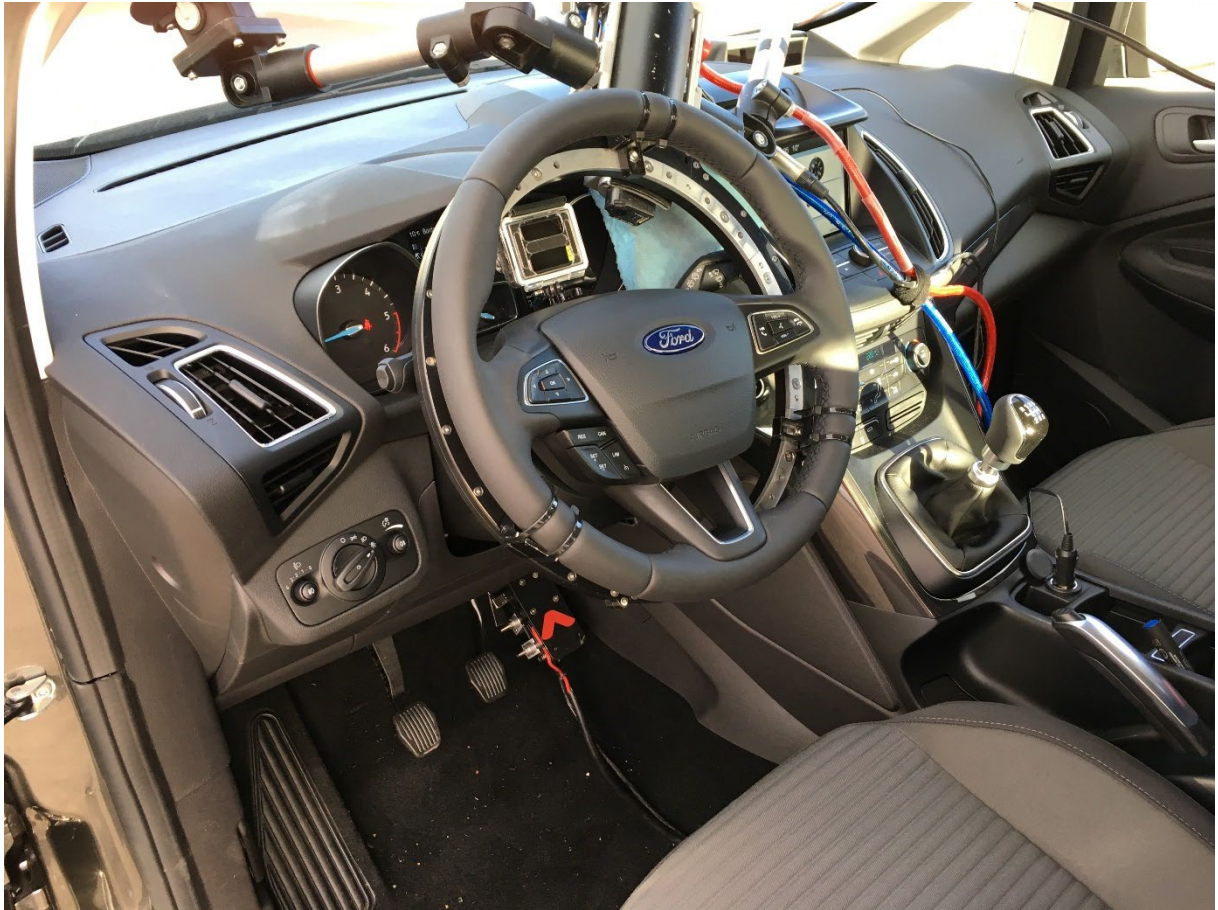
Bild 11: Lenkroboter Vehico CS1200, montiert in einem anderen Fahrzeug
