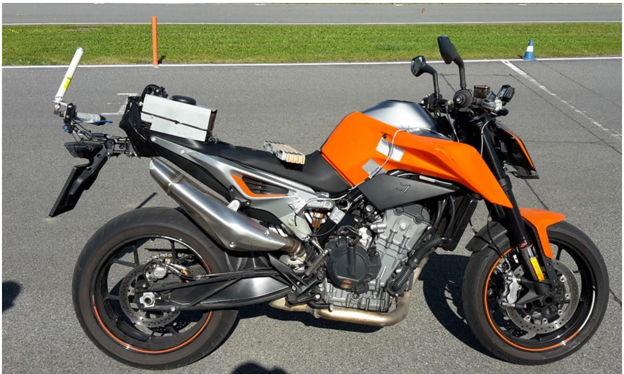
Bild 3-5: Versuchsmotorrad (KTM 790 Duke) mit Messaufbau: Trägheitsnavigationssystem am Soziussitz und WLAN Antenne über der Kennzeichenhalterung
