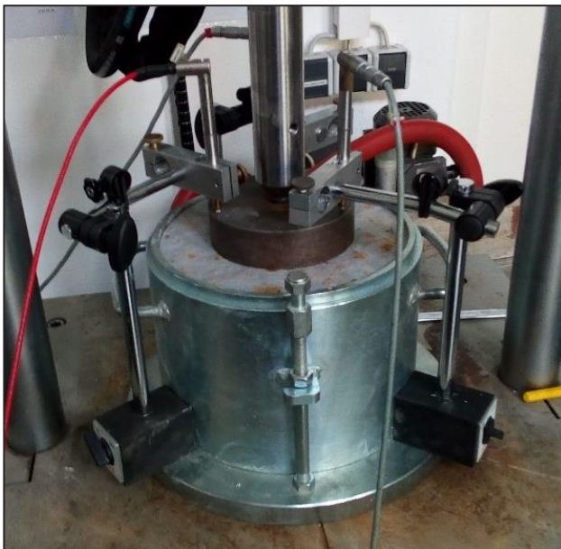
Bild 9-3 Versuchsanordnung zyklischer Ödometerversuch
