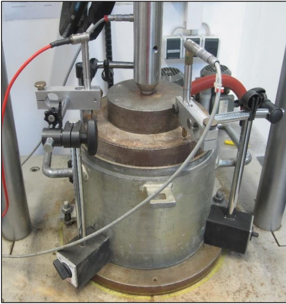
Bild 9-1 Versuchsanordnung zyklischer Ödometerversuch
