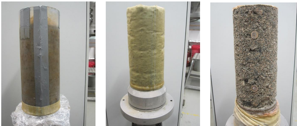
Bild 8-4 Probekörperherstellung: Links - Probekörper im Kunststoffzylinder, nach Entfernen der Stahlschalung, Mitte - Probekörper mit Gummimembran, Rechts – vollständig ausgeschalteter Probekörper nach Versuchsdurchführung (Chloritgneis)
