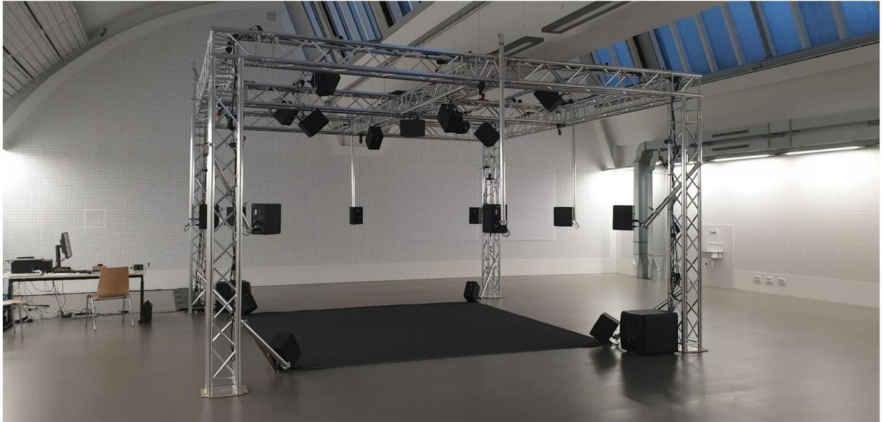
Bild 2.2: Mixed Reality Design Lab von TU Berlin und UdK Berlin. Installation zur Synthese von virtuellen oder augmentierten akustischen Realitäten durch ein Higher-Order-Ambisonics-Lautsprechersystem.
