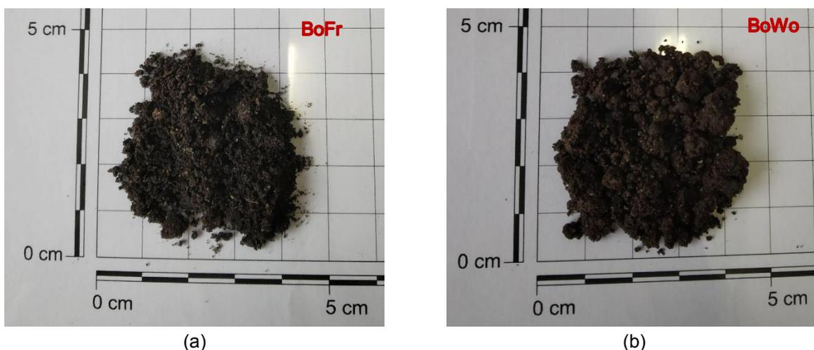
Bild 4-3: Erdfeuchte Ausgangsböden (a) BoFr (b) BoWo
