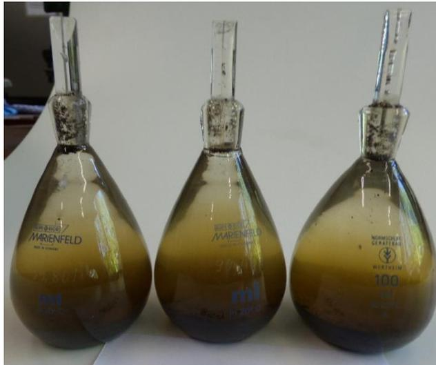
**Bild 4-20: Schwimmendes organisches Material während der Kapillarpyknometerversuche**
