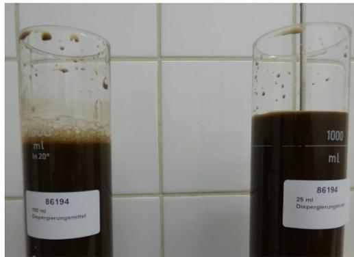
**Bild 4-17: Aufschäumen von Sedimentationsanalyseproben von BoWo Böden mit 100 ml Dispergierungsmittel (Natriumpyrophosphat). Bei Zugabe von 25 ml Dispergierungsmittel (Natriumpyrophosphat) wurde kein Aufschäumen beobachtet.**
