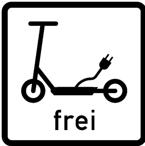
Bild 2-4 : Zusatzzeichen „Elektrokleinstfahrzeuge frei“; Quelle: (BMDV, 2019)
