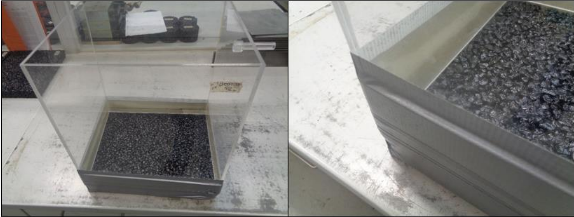
Bild A 318: Aufbau Abdichtung an WSV-Platten
