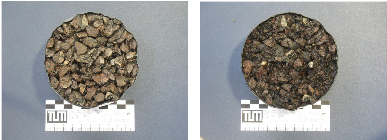
Bild 3 Probekörper des offenporigen Asphaltes mit Gesteinskörnung GK 7 vor (links) und nach (rechts) den 28 Frost-Tau-Wechseln im CDF-Versuch
