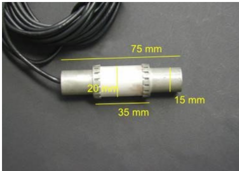
Bild 3.1: Transducer ACS S807 (Foto:BAM)
