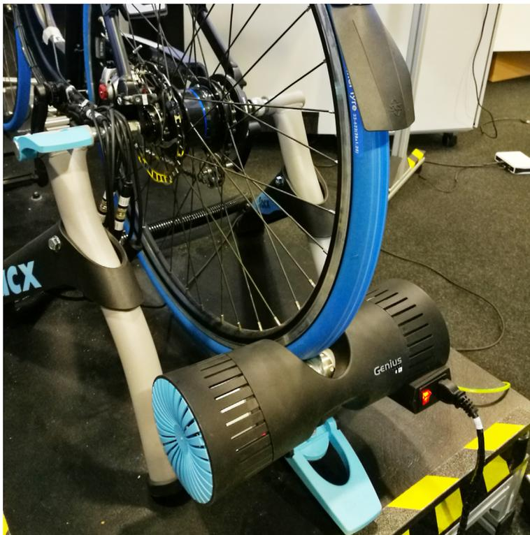
**Bild 4: Hinterrad an der Widerstandseinheit des Aktuators**
