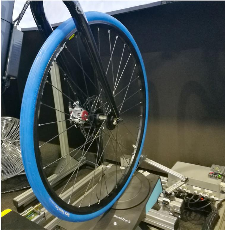
**Bild 3: Vorderrad auf dem Lenklager**
