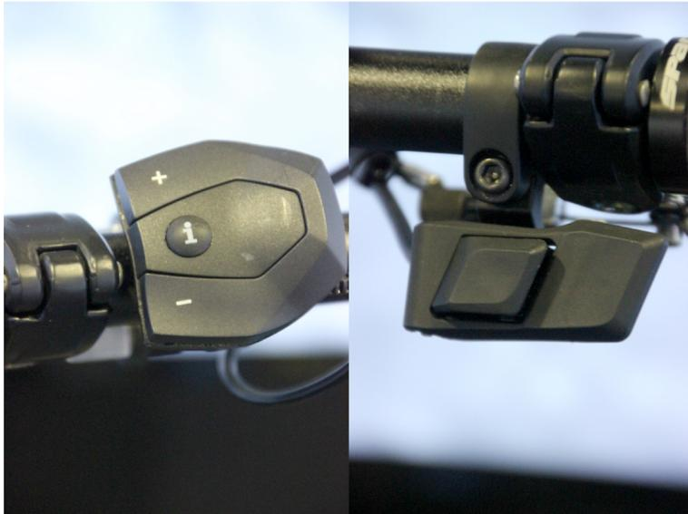
**Bild 5:** Lenkertaster zur Pedelec-Simulation (links) und für die elektronische 11-Gang-Schaltung (rechts)
