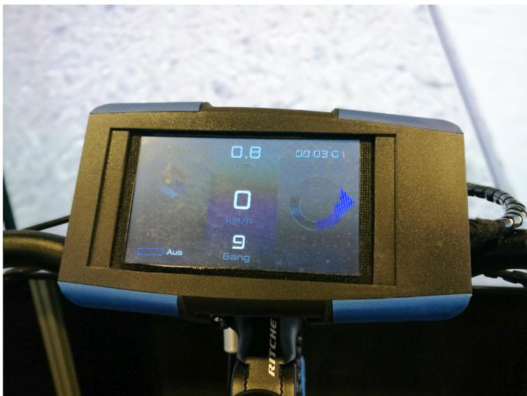
**Bild 6:** Multifunktionsdisplay, mittig am Lenker angebracht
