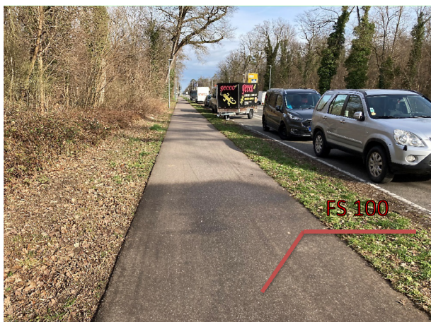
Bild 72: Betreuter Streckenabschnitt mit FS 100 (dunkler Bereich im Bildvordergrund) nach 24 Stunden in Karlsruhe (Bild: Wiesler)
