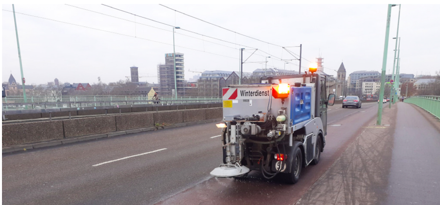
Bild 67: Austragung der Streustoffe vor der Messung in Köln (Bild: WIESLER)
