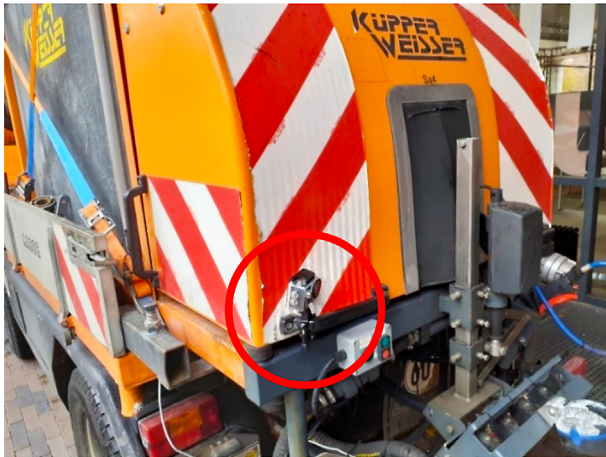
Bild 34: Anbringung der rückwärtigen Kamera an einem Fahrzeug des AfA mit Sprühbalken für FS 100 (Bild: WIESLER)
