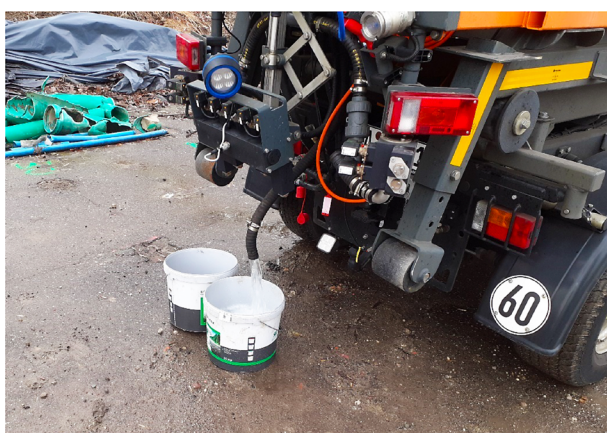
Bild 68: Wiegetest für Sole-Dosierung (Bild: WIESLER)
