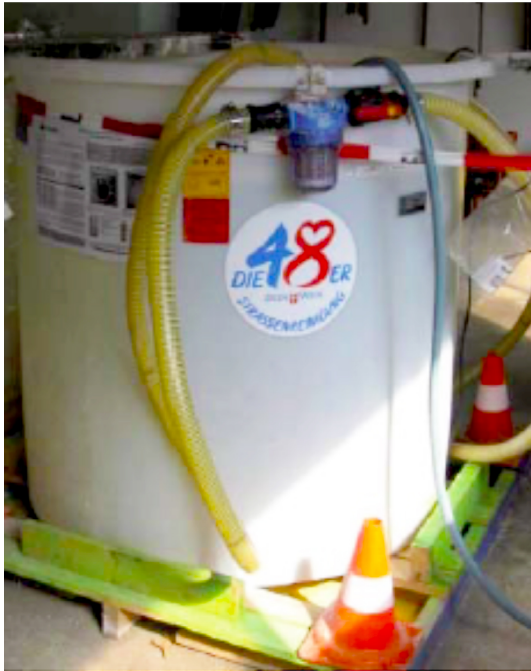
Bild 14: Semimobile Solemischanlage in Wien [NUTZ 2017]
