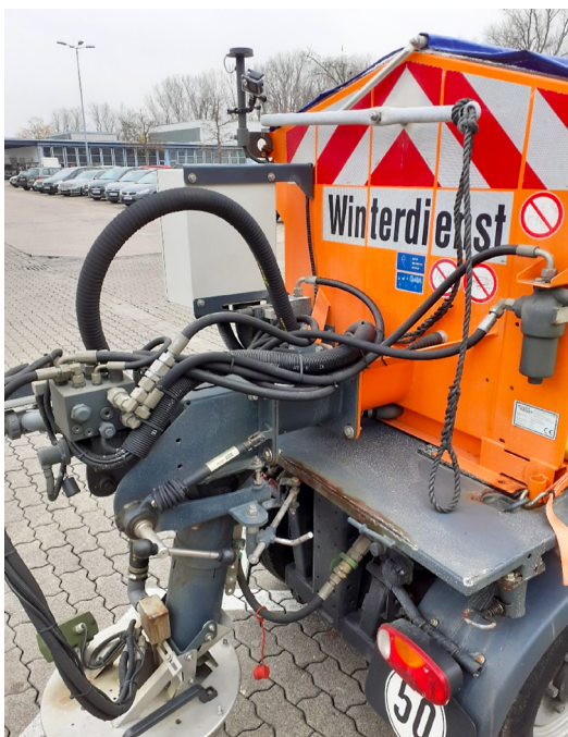
Bild 9: Streumaschine mit Streuteller für FS 30-Einsatz (Bild: WIESLER)
