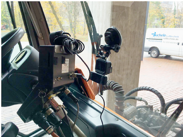
Bild 33: Anbringung der Frontkameras zur Dokumentation der Winterdienstseinsätze (Bild: WIESLER)
