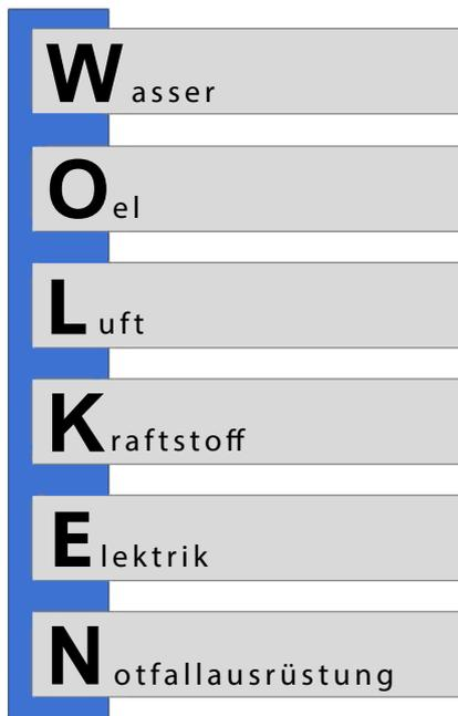
**Bild 5-3: Prüfprinzip WOLKEN für die Fahrzeugwartung (Grafik: STUVA)**
