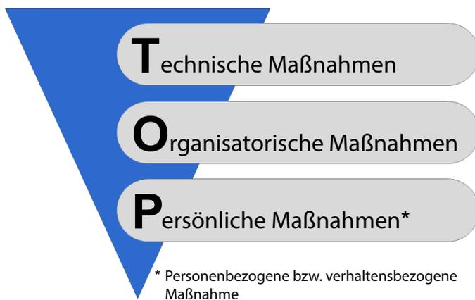
**Bild 5-1: Hierarchie des TOP-Prinzips zur Umsetzung von Schutzmaßnahmen (Grafik: STUVA)**
