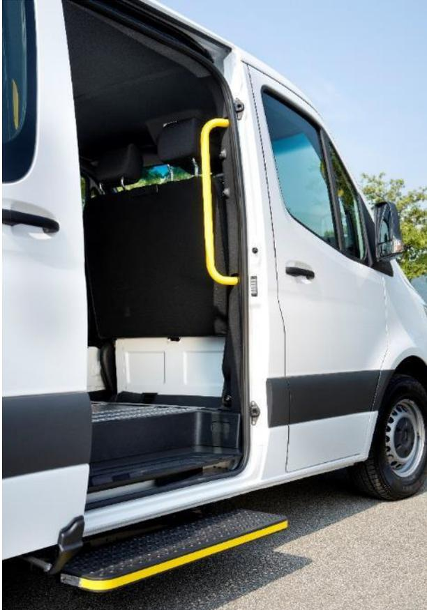
**Bild 4-6:** Beispiel für eine elektrisch ausfahrbare Trittstufe in Lochblechausführung (Foto: MobilTec GmbH, Bingen)
