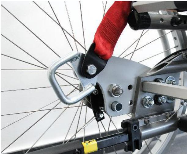
**Bild 4-14: Kraftknotenadapter mit Schwerlastöse an einem Rollstuhl (Foto: AMF Bruns GmbH & Co. KG)**
