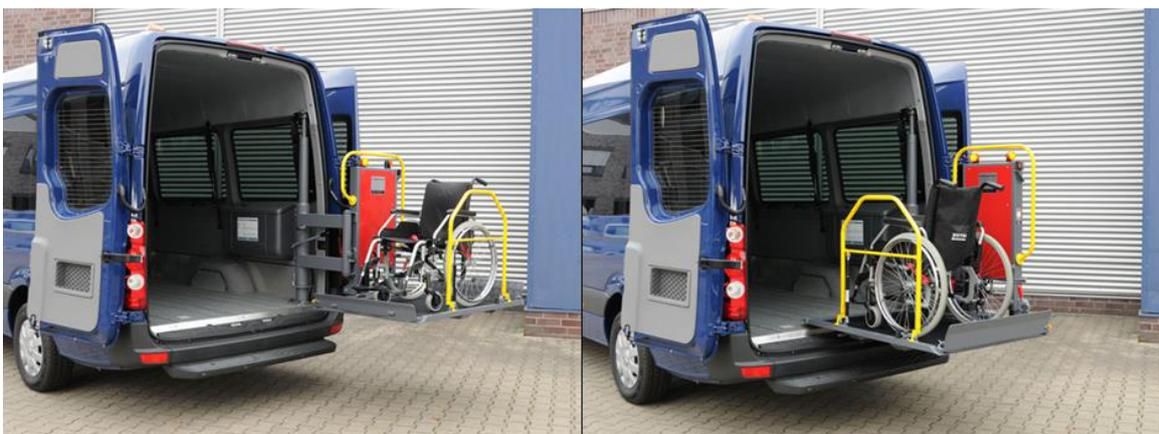
**Bild 4-4: Schwenklift in angehobener Betriebsstellung zur Seite geschwenkt (links) und in angehobener Arbeitsstellung (rechts)** (Fotos: AMF-Bruns GmbH & Co. KG)
