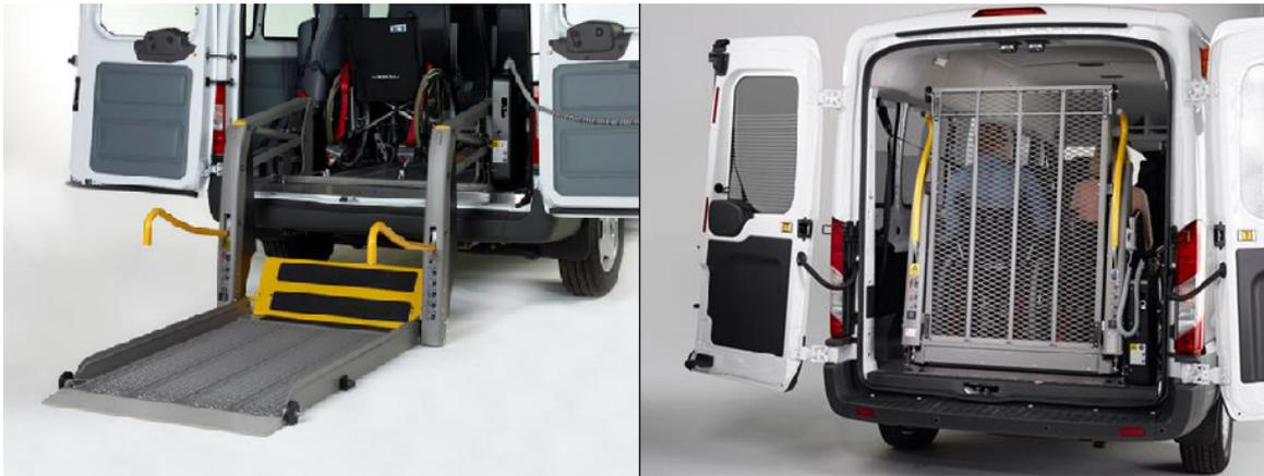
**Bild 4-3: Linearlift in abgesenkter Arbeitsstellung (links) und in Fahrstellung (rechts)**
