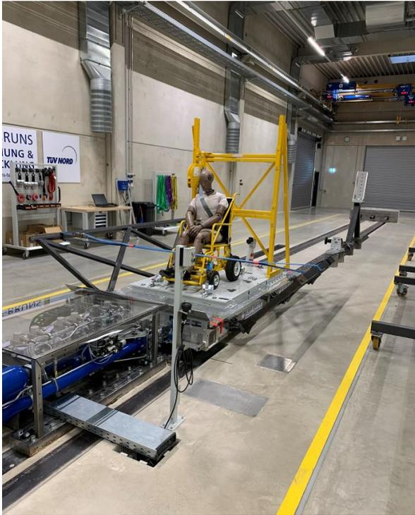
**Bild 3-2: Dynamische Testanlage zur Überprüfung von Anforderungen an Rollstühle gemäß DIN 75078-2 oder ISO 7176-19 (Foto: Boenke)**
