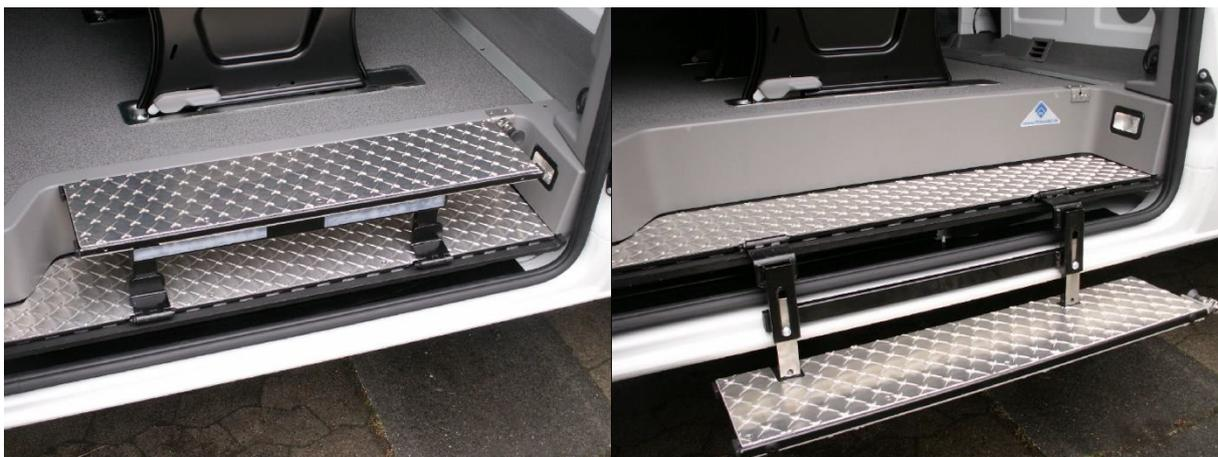
**Bild 4-7:** Beispiel für eine manuell zu betätigende Klapptrittstufe, eingeklappt (links) und ausgeklappt (rechts) (Fotos: FES Innovations GmbH)
