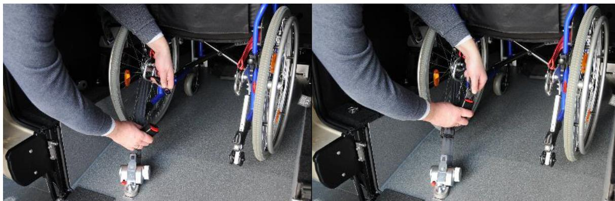
**Bild 4-18: Verbinden des Rollstuhl-Rückhaltesystems mittels Gurtschlaufe und Öse am Kraftknoten (Fotos: AMF Bruns GmbH & Co. KG)**
