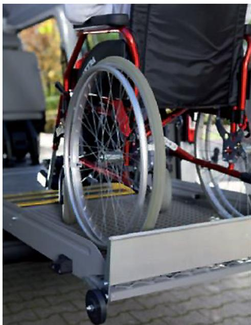
**Bild 4-5: Plattform mit Abrollsicherung in Betriebsposition (Foto: BGW/Eva Haeblerle)**
