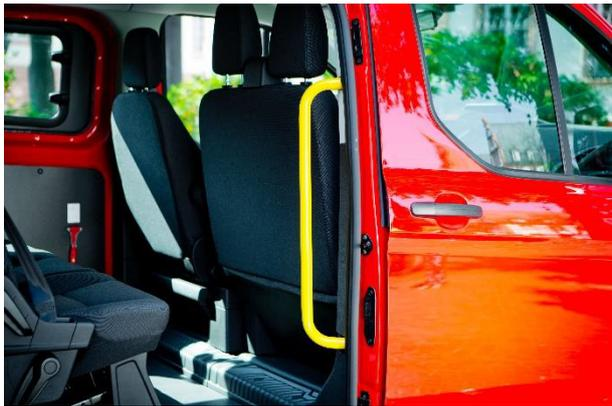
Bild 4-8: Visuell kontrastierende Haltegriff am Seiteneinstieg eines KMP (Foto: MobilTec GmbH, Bingen)
