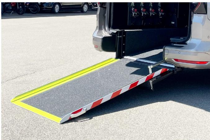
**Bild 4-2: Rampe an einem Fahrzeug mit Heckausschnitt (Foto: PARAVAN GmbH)**
