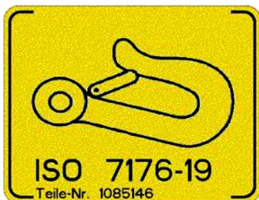
**Bild 3-3: Plakette für die Kennzeichnung der Befestigungspunkte für das RRS am Rollstuhl**
