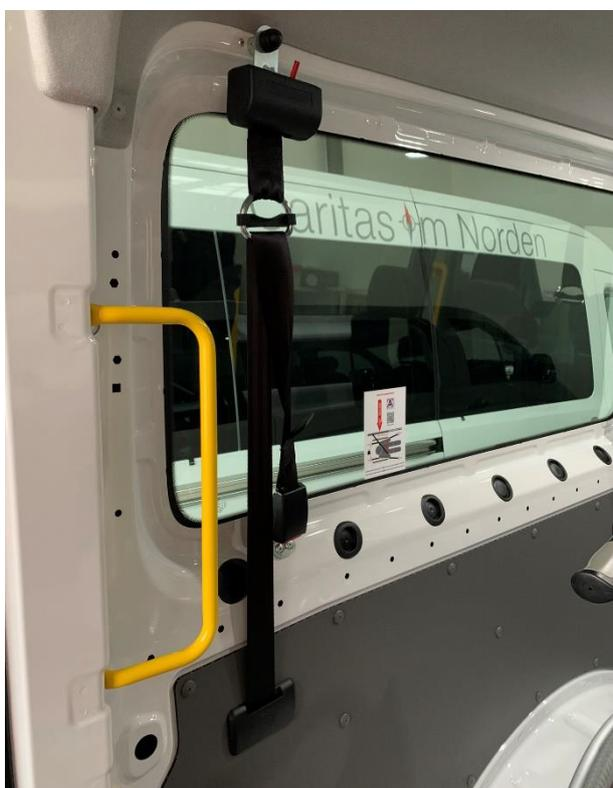
**Bild 4-13: Schultersträggurt mit oberem Verankerungspunkt in einem KMP (Foto: Boenke)**
