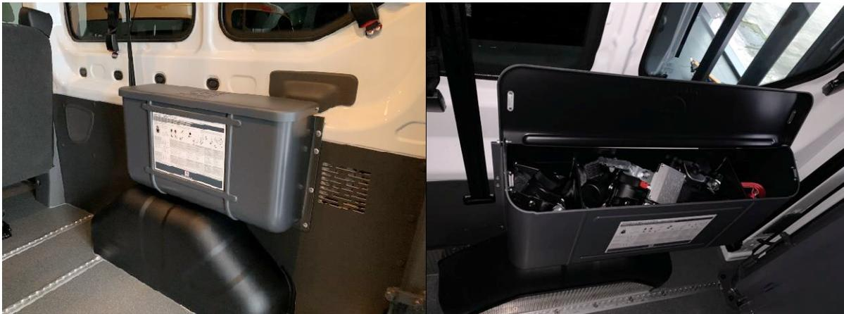
**Bild 4-12: Aufbewahrungsbox für Elemente der Rückhaltesysteme mit Kurzanleitung für die Sicherung auf der Box (Fotos: Boenke)**
