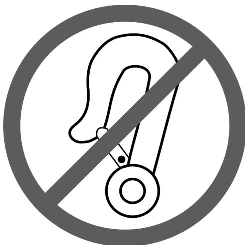
**Bild 3-4: Symbol für Rollstühle, die nicht für den Gebrauch als Sitz in einem Kraftfahrzeug geeignet sind**
