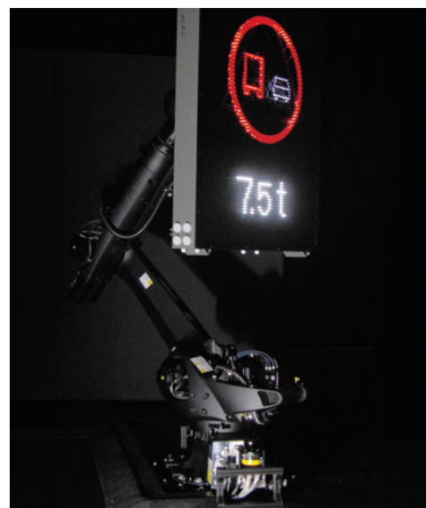
Robotisches Goniophotometer mit großem Wechselverkehrszeichengeber in LED-Ausführung.
