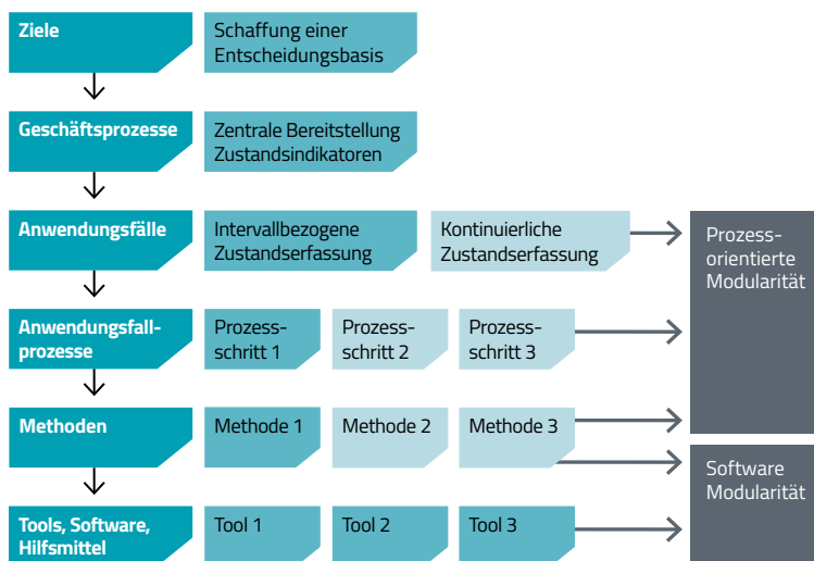
Modularer Aufbau des Digitalen Zwillings Brücke.
