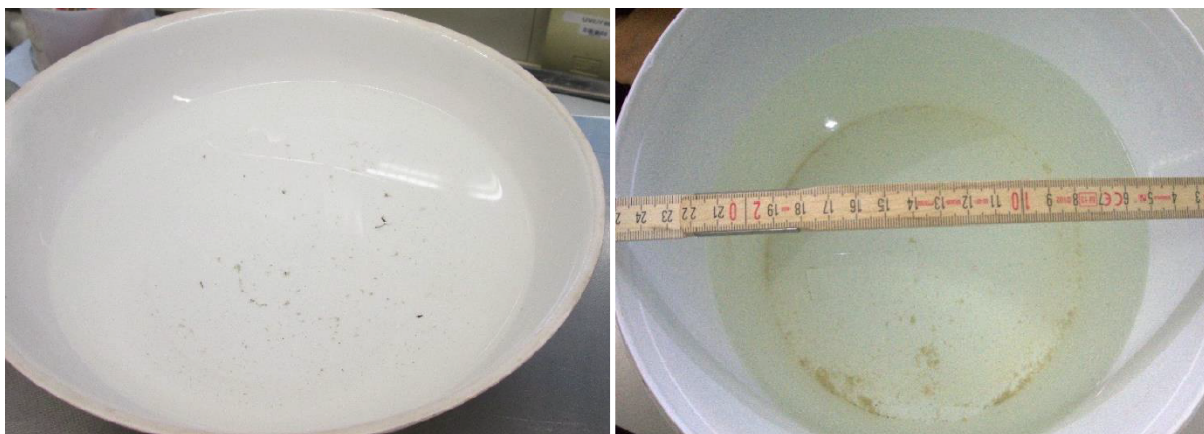
Bild 3-12: Wasserprobe des Vor- und Rücklaufs (von links nach rechts), am Boden hat sich die Sedimentfracht bzw. die Ausfällungen abgesetzt.
