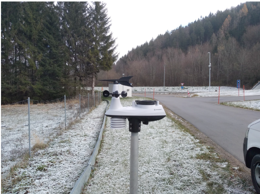
Bild 3-1: Vor Ort installierte Wetterstation
