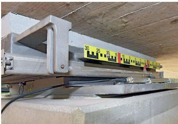
**Bild 6:** Instrumentiertes Kalottenlager (HAARDT et al., 2017)
