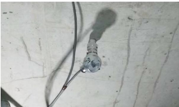
**Bild 11: Pt100 Temperatursensor an der ÖBB Steyrtalbrücke (GEIER et al., 2016)**
