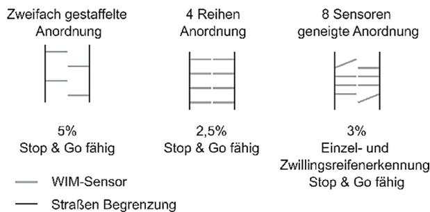
**Bild 9: Messgenauigkeit entsprechend unterschiedlicher Anordnungsmöglichkeiten der Quarz-Piezo-Sensoren nach (Kistler Group, 2020)**
