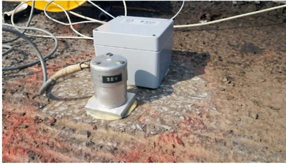
**Bild 60: Installation eines Beschleunigungssensor mit Klebemittel (PIRSKAWETZ et al., 2022)**
