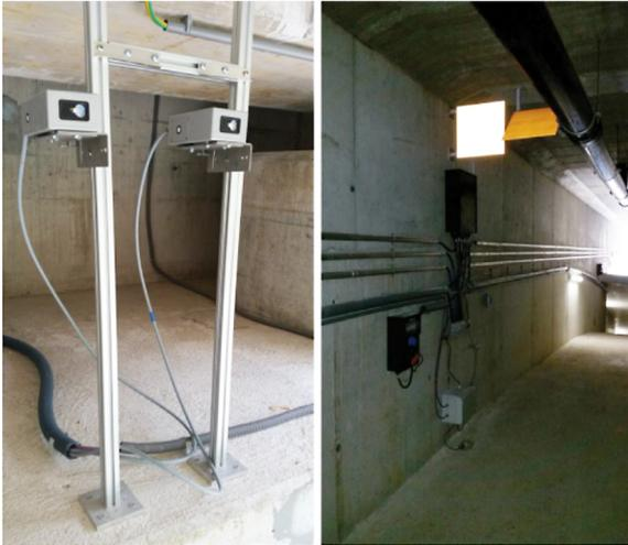
**Bild 44:** Laserdistanzmessung an der ÖBB Steyrtalbrücke (links) und Reflektoren (rechts) (GEIER et al., 2016)
