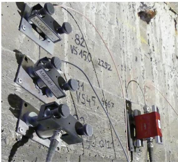
**Bild 90:** Anordnung der AE-Sensoren an Magnethaltern (links) und eines externen Vorverstärkers (rechts) (PIRSKAWETZ et al., 2022)
