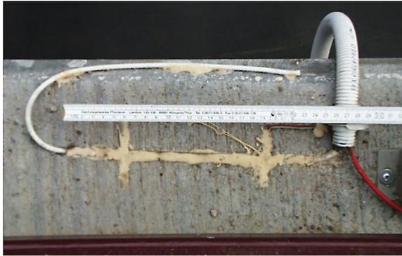
**Bild 39: Faser-Bragg-Gitter-Sensor an einer Brücke (TUE and DIETZ, 2005)**
