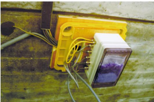
**Bild 31:** Aufbau und Befestigung des Datenerfassungssystems (ohne Abdeckung) (SCHIEGG and BÖHNI, 2000; SCHIEGG, 2002)
