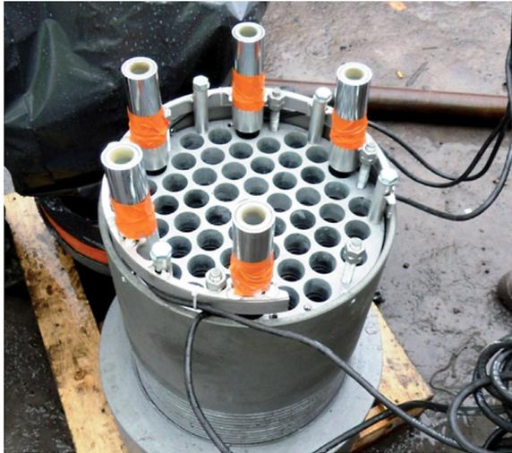
**Bild 83: Montage magnetoelastischer Sensoren zur Kraftmessung (GLÄSER et al., 2014)**
