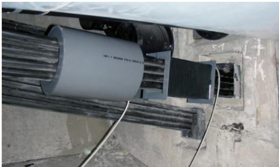
**Bild 80: Magnetoelastischer Sensor am Spannanker (BUDELMANN et al., 2009)**
