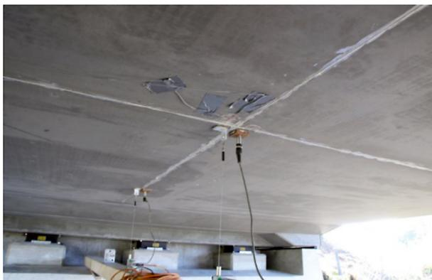
**Bild 99: Einsatzbeispiel der faseroptischen Sensoren zur Messung in zwei orthogonalen Richtungen (SCHRAMM and FISCHER, 2019)**
