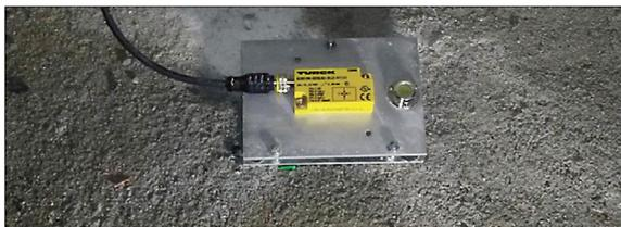
**Bild 51: Applikation eines Neigungssensors (GEIER et al., 2016)**
