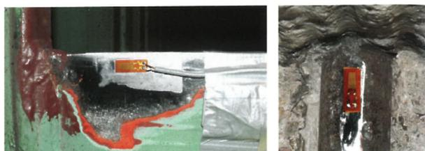
**Bild 66: Installation eines Dehnungsmessstreifens auf Baustahl (links) und auf Bewehrungsstahl (rechts) (KROHN, 2014)**
