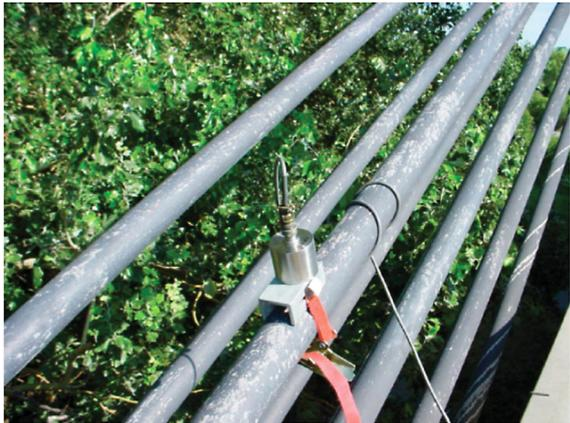
**Bild 85: Befestigung des Beschleunigungssensors auf einem Schrägseil (GEIER and PETZ, 2004)**
