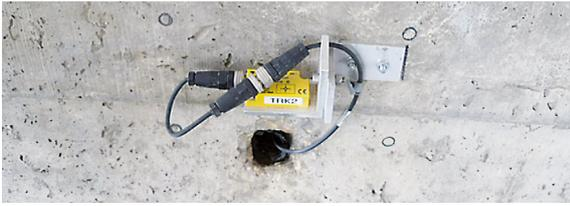
**Bild 53: Installation eines Neigungssensors an der Seitenhafenbrücke (GEIER et al., 2014)**
