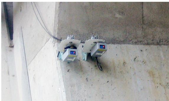
**Bild 46: Laser-Distanzsensoren an der Kammerwand einer semi-integralen Rahmenbrücke (GEIER et al., 2014)**
