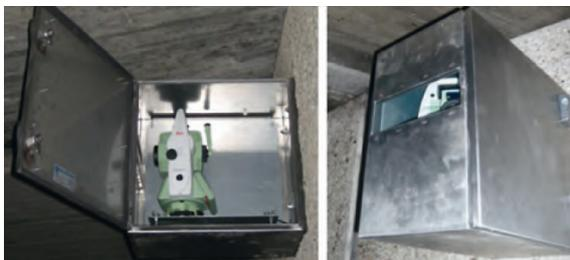
**Bild 43:** Installationsbeispiel eines Tachymeters für Verformungsmessungen (SCHNELLENBACH-HELD et al., 2015a) (Beispielsammlung Monitoring 5.2)
