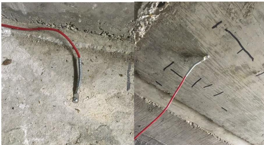
Bild 5: Temperatursensoren an der Überbauunterkante (links) und Fahrbahnunterkante (rechts), Quelle: Lucks Technologies GmbH
