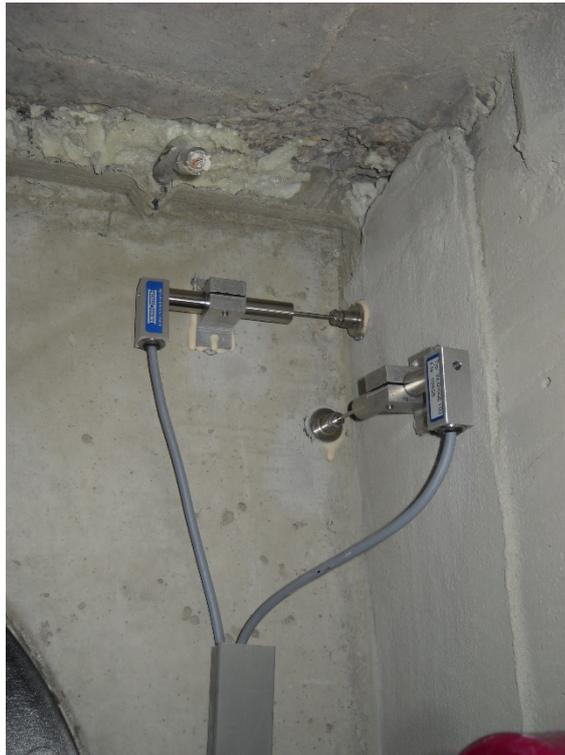
Bild 3: Klebung Wegaufnehmer zur Kontrolle horizontaler Verschiebungen, Quelle: Schömig-Plan Ingenieurgesellschaft mbH
