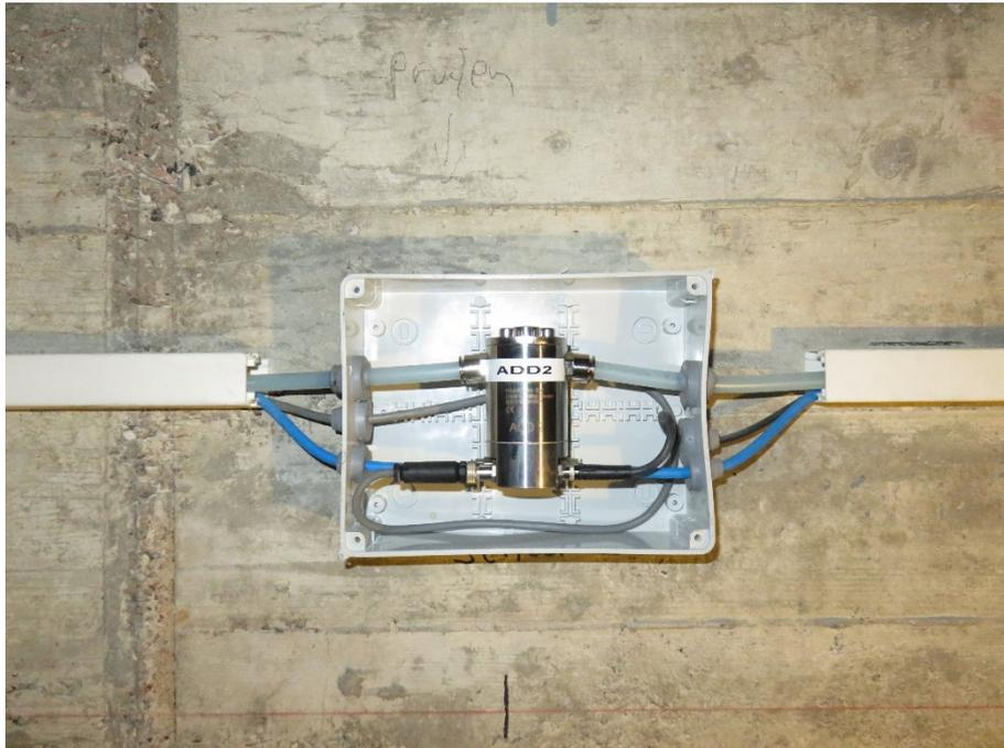
Bild 4: Installation und Messstelle der Präzisionsschlauchwaage,
