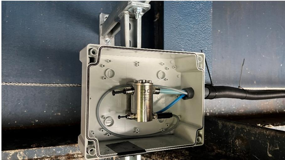
Bild 3: Digitale Schlauchwaage, Quelle: Dr. Hesse und Partner Ingenieure
