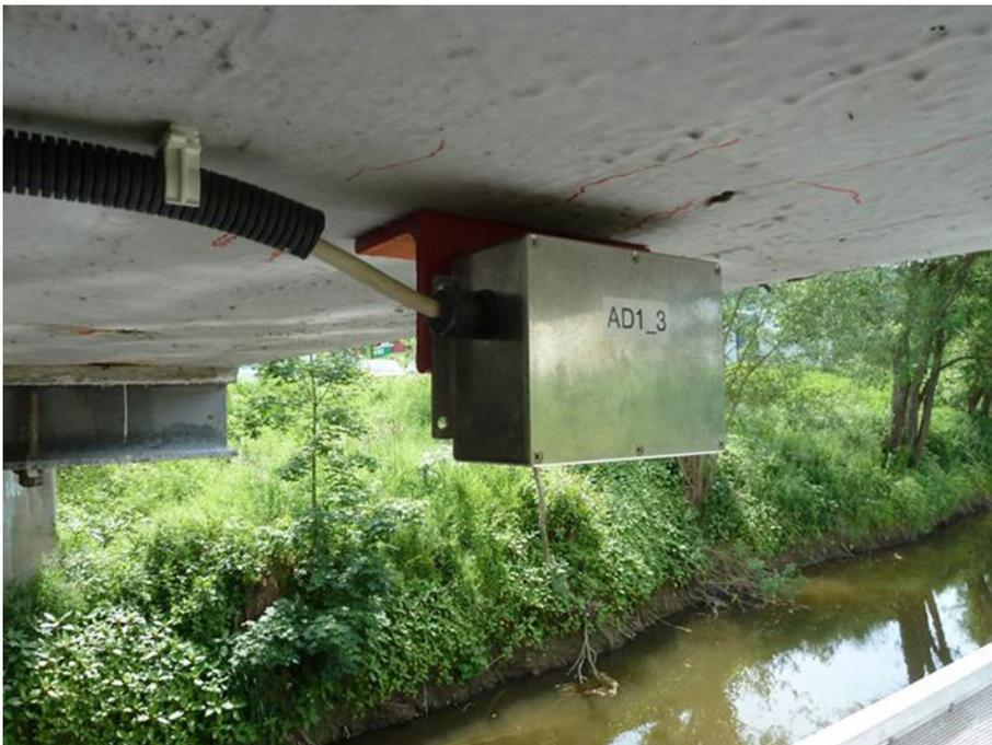
Bild 4: Installation des Beschleunigungssensors, Quelle: VCE Vienna Consulting Engineers ZT GmbH, BBV Systems GmbH
