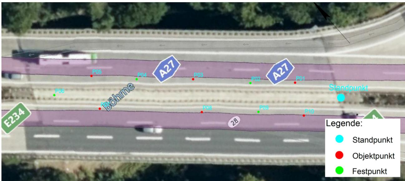
Bild 4: Übersicht der Messpunkte, Quelle: RMK Vermessung Geodatenservice
