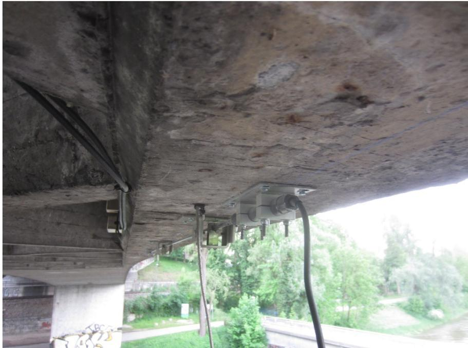
Bild 4: Ansicht integraler Dehnungsmessung mit CFK-Stange, Quelle: Konstruktionsgruppe Bauen AG, Kempten, Projekt-ID 12-1-432
