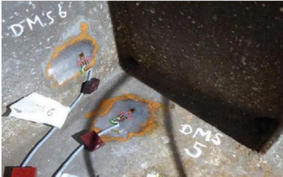
Bild 3: Anbringung der Dehnungsmessstreifen, Quelle: Institut für Konstruktiven Ingenieurbau, Universität der Bundeswehr München; IXIST Measurement GmbH
