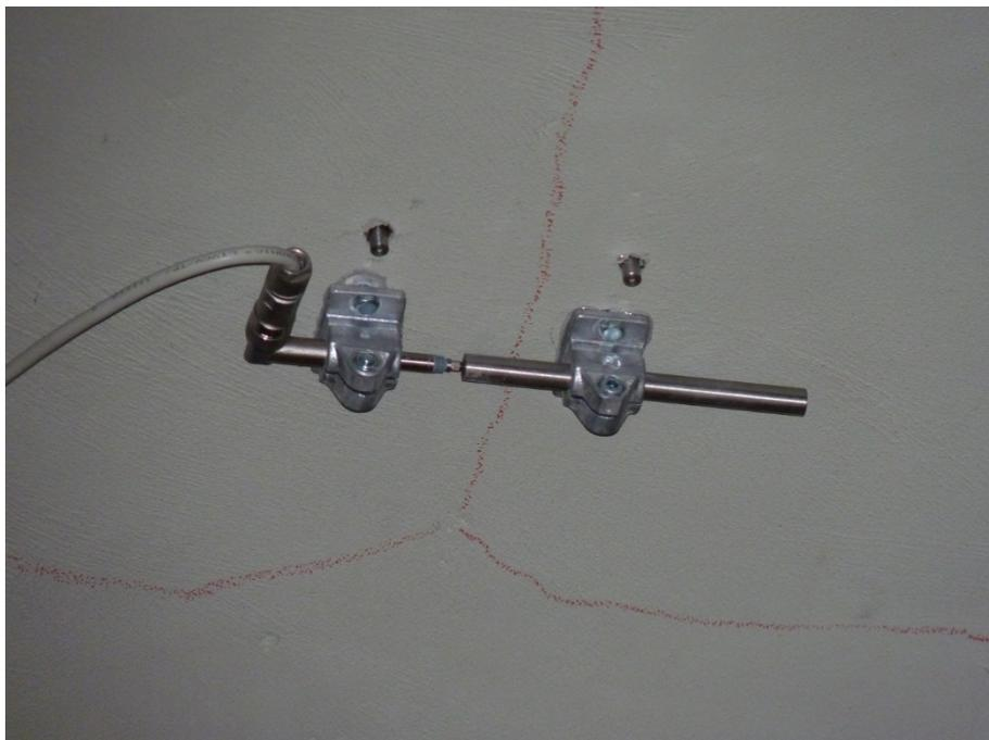
Bild 2: Wegaufnehmer zur Überwachung der Risskontrolle eines detektierten Risses, Quelle: Landesamt für Straßenbau und Verkehr Mecklenburg-Vorpommern
