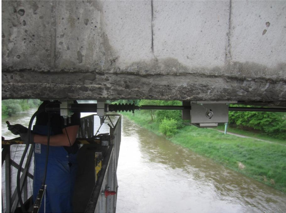
Bild 3: Seitenansicht integraler Dehnungsmessung mit CFK-Stange, Quelle: Konstruktionsgruppe Bauen AG, Kempten, Projekt-ID 12-1-432
