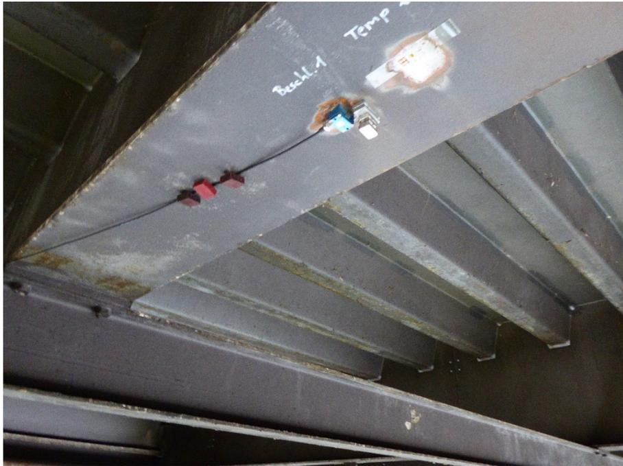
Bild 5: Installation Beschleunigungssensoren, Quelle: IXIST Measurement GmbH
