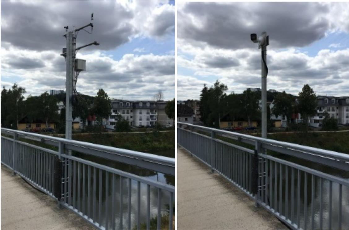
Bild 3: Wetterstation (li) und Kamera (re), Quelle: iNDTact GmbH
