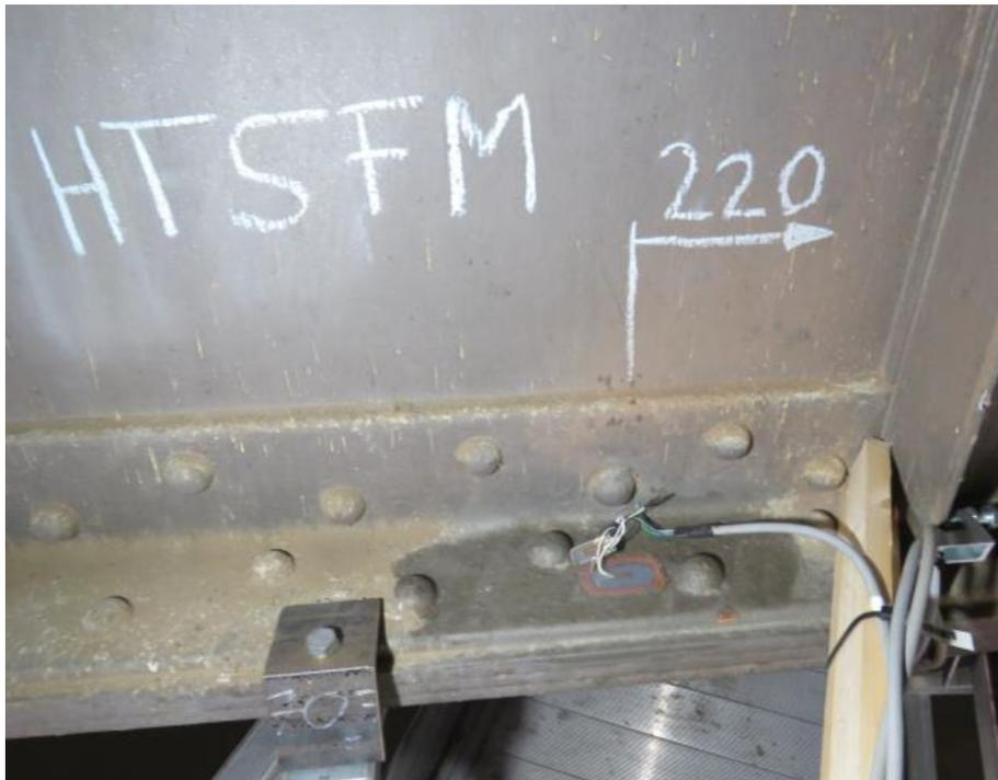
Bild 2: Oberflächenapplikation der Dehnmessstreifen, Quelle: GMG Ingenieurgesellschaft mbH
