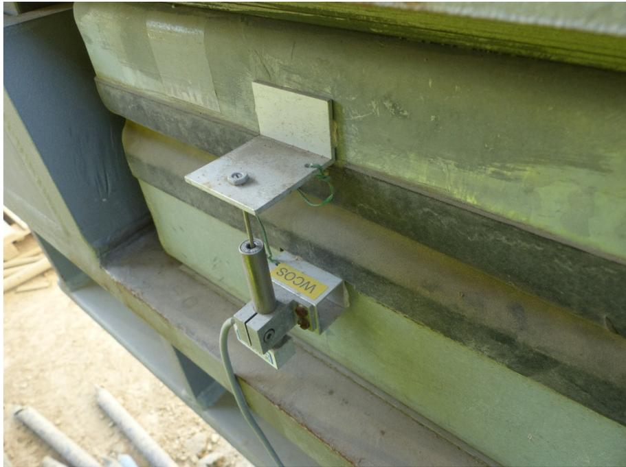
Bild 3: Klebung Wegaufnehmer zur Kontrolle vertikaler Verschiebungen der Federelemente, Quelle: Schömig-Plan Ingenieurgesellschaft mbH
