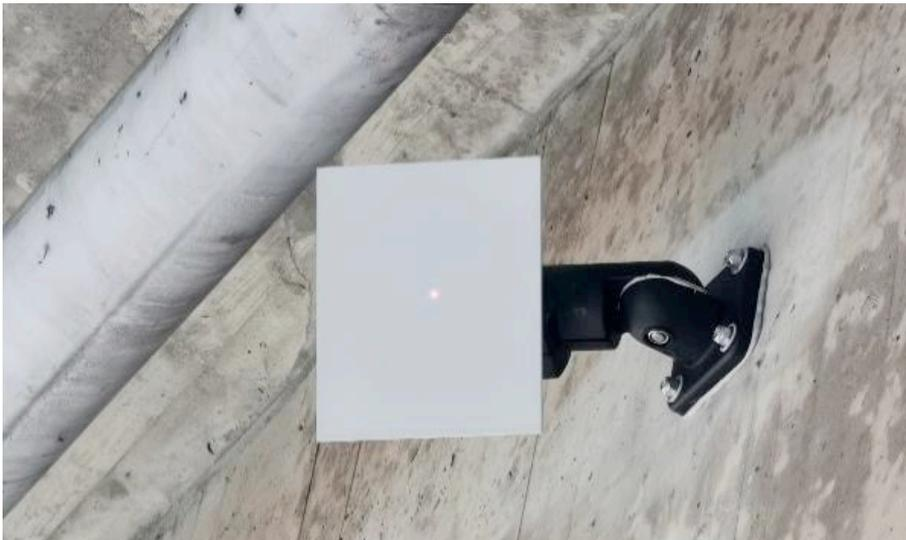
Bild 9: Messziel am Überbau, Quelle: Lucks Technologies GmbH
