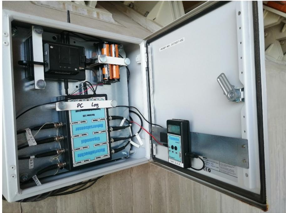
Bild 6: Messkasten mit Datenlogger und Widerstandsmessmodul, Quelle: KBauMV FH Wismar
