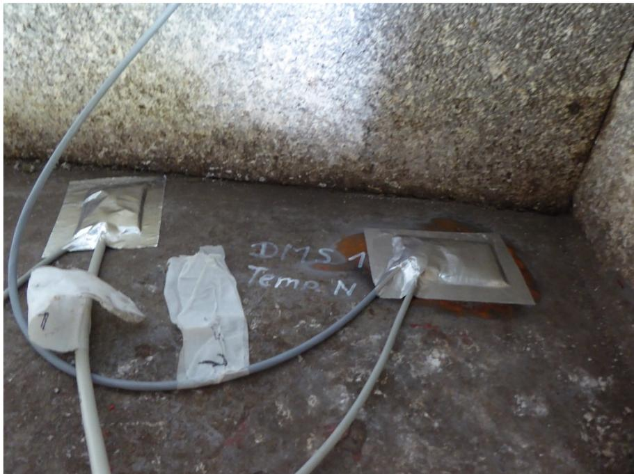
Bild 4: Anbringung der Temperatursensoren, Quelle: Institut für Konstruktiven Ingenieurbau, Universität der Bundeswehr München; IXIST Measurement GmbH
