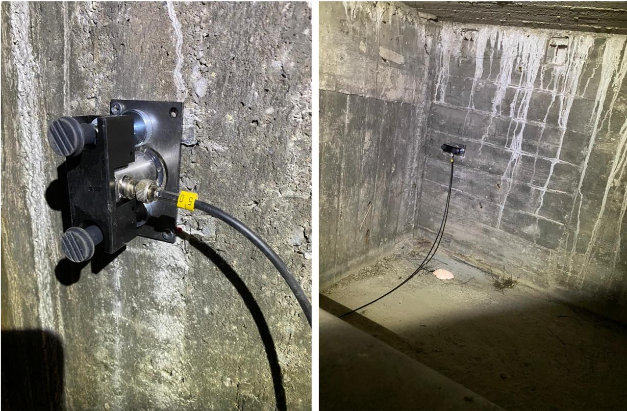
Bild 3: Installation eines AE-Sensors an der Betonoberfläche, Quelle: Bilfinger Noell GmbH
