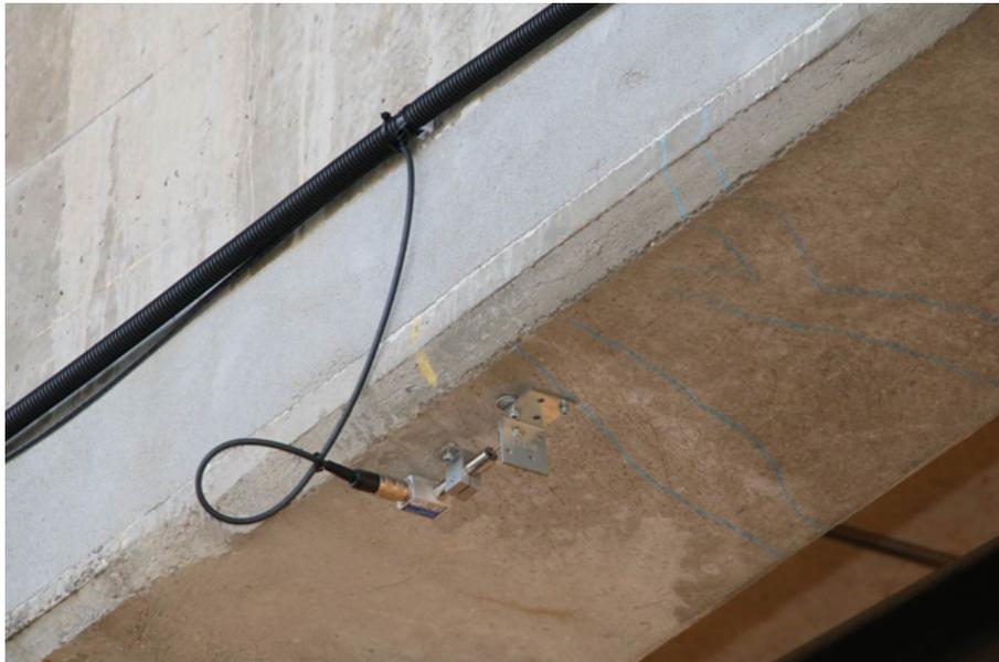
Bild 5: Installation Wegaufnehmer an Unterkante Steg, Quelle: ILEK, Universität Stuttgart
