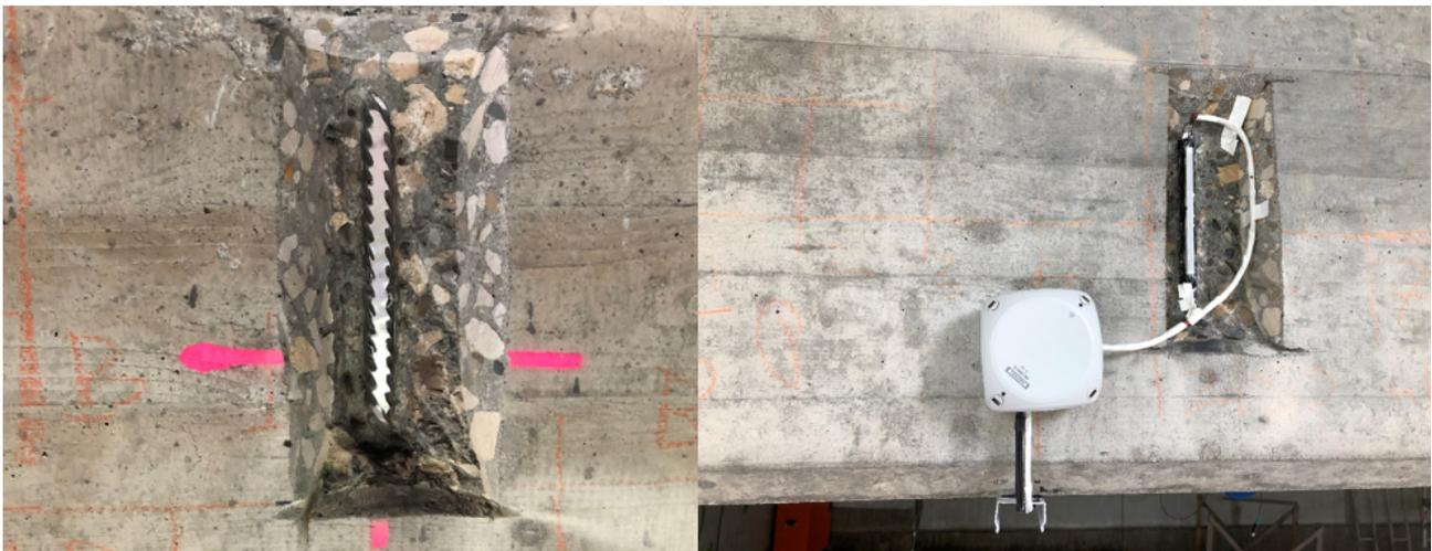
Bild 2: Messstelle zur Erfassung der Bügeldehnungen (FBG) während der Installation, Quelle: Büro für Strukturmechanik GmbH
