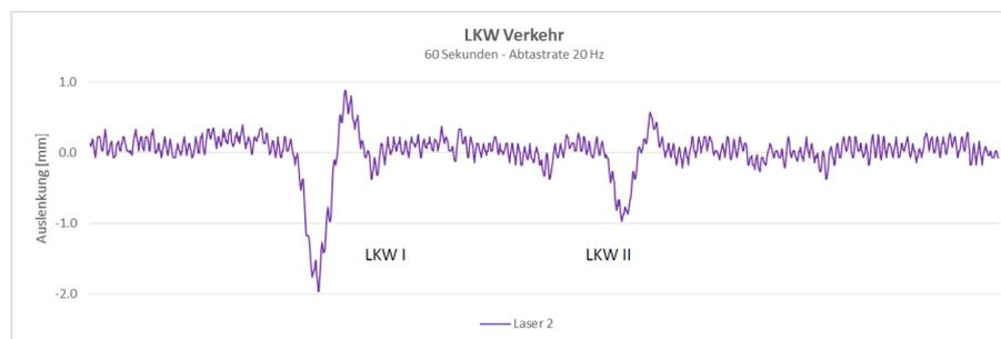
Bild 7: Verformungsverhalten eines Messziels bei LKW Überfahrten, Quelle: Lucks Technologies GmbH
