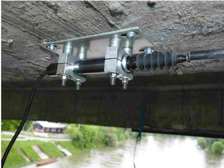
Bild 5: Integrale Messung, Anschluss Wegaufnehmer an CFK-Stange,
