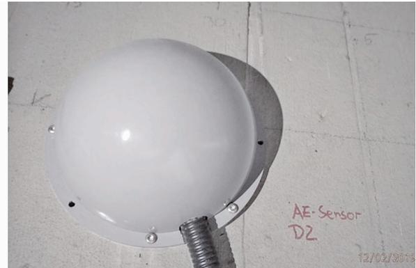
Bild 2: Montage der AE-Sensoren, Quelle: Ingenieurbüro Schießl Gehlen Sodeikat GmbH, (Sodeikat et al. 2019)
