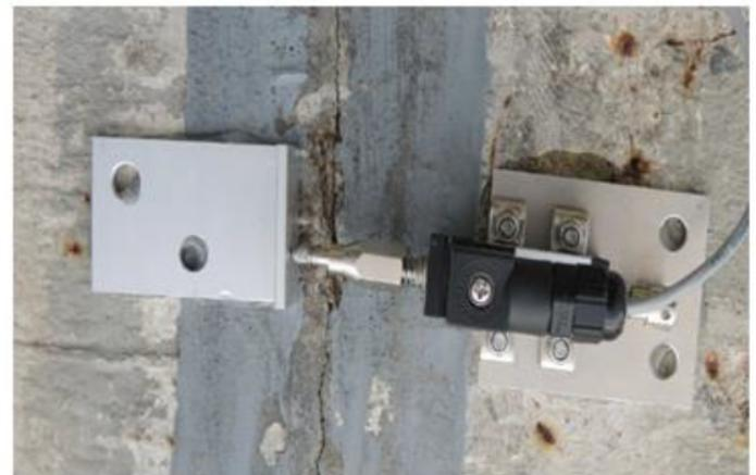
Bild 2: Riss an der Koppelfuge (li) und installierter Wegsensor mit Datenlogger (re),
