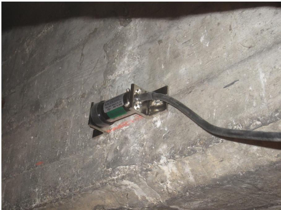
Bild 6: Integrale Messung, Anschluss Wegaufnehmer an Carbonstange,
