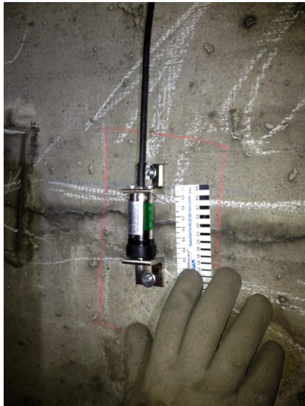
Bild 2: Montierter Dehnmessstreifen am Schrägriss, Quelle: TÜV Rheinland LGA Bautechnik GmbH
