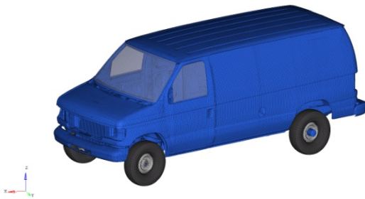
Bild 12: Finite-Element-Modells des 2200 kg schweren Lieferwagens
