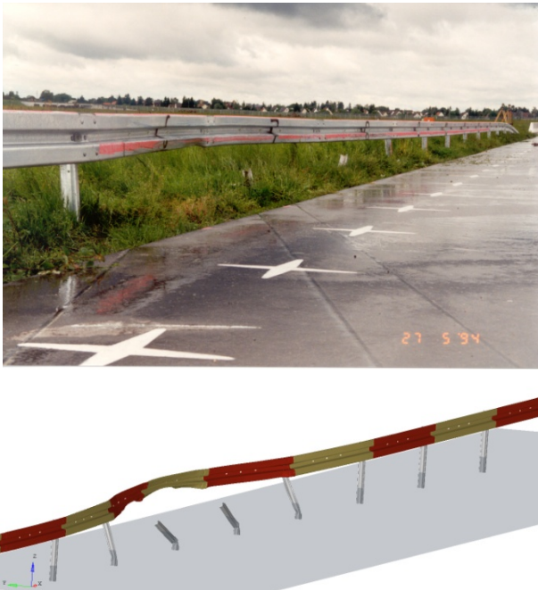
Bild 32: Verformung der ESP 4.0 in der Anprallprüfung (oben) und in der Simulation (unten)
