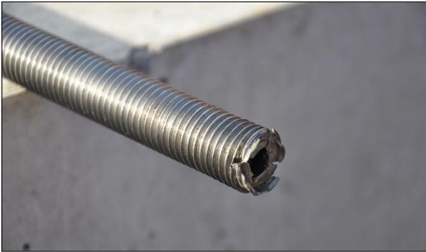
Bild 3-20: Teil des Höhenjustierelements JTU
