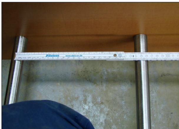
Bild 3-3: Schablone zur Fixierung der Justierelemente
