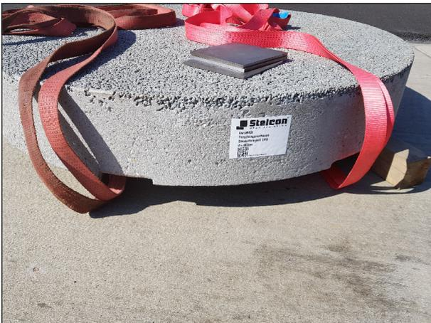
Bild 3-12: Rundes Fertigteil mit OPB-Oberfläche
