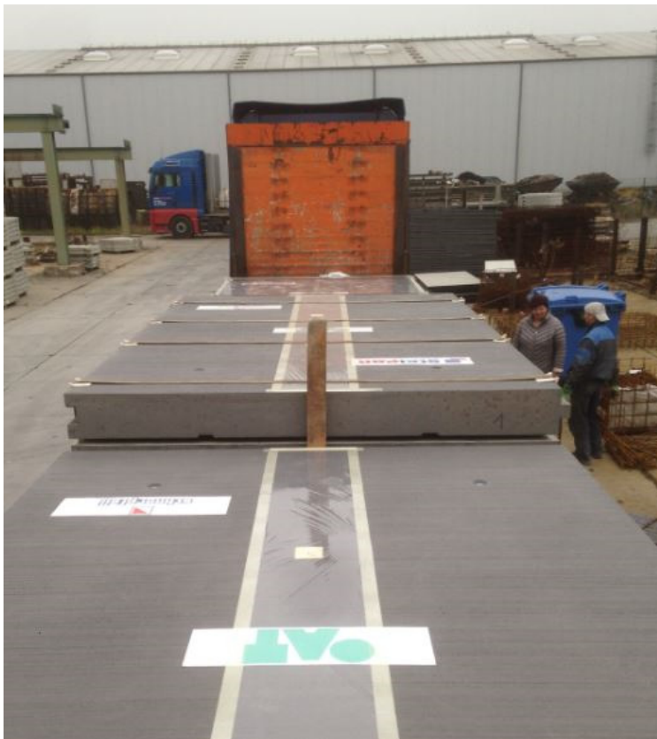
Bildbeispiel: Verladene Betonfertigteile, teilweise bereits gesichert.
