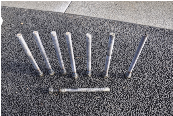
Bild A.63: Teile der Justierelemente JTU der Platten 11 und 12
