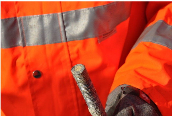
Bild A.57: Element des Höhenjustiersystems JTU nach Nutzung der Unterpressfunktion
