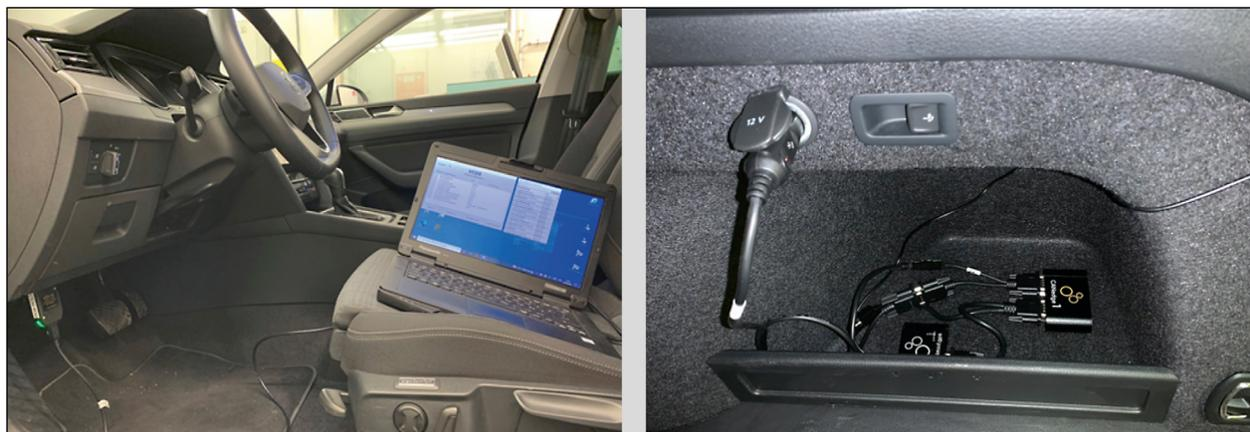
Bild 5-3: VCDS (links) und CSS CANedge (rechts), verbunden mit der OBD-Schnittstelle des Fahrzeugs
