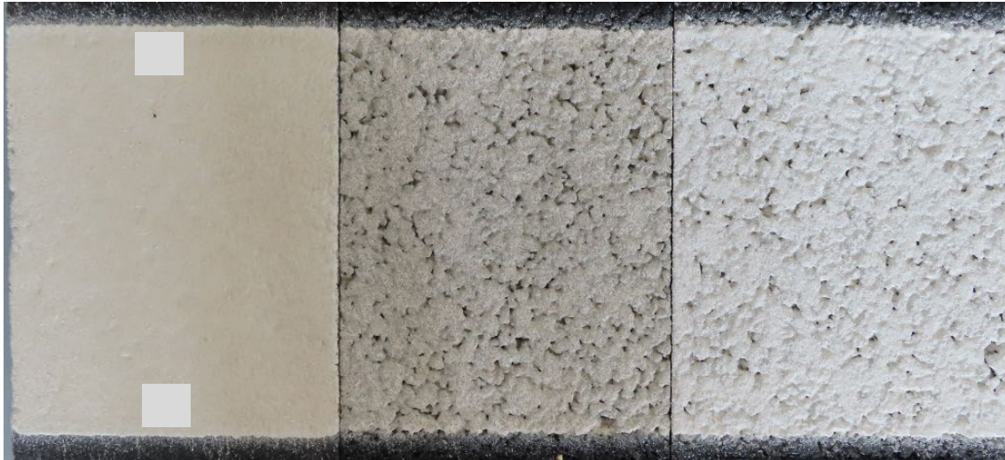
Bild 10: HS-Farbe, Typ I, Neuzustand a) Probe S2 mit 300 µm auf Gussasphalt b) S2 mit 300 µm auf SMA und c) Probe S5 mit 600 µm auf SMA (2fach appliziert, jeweils mit NSM)
