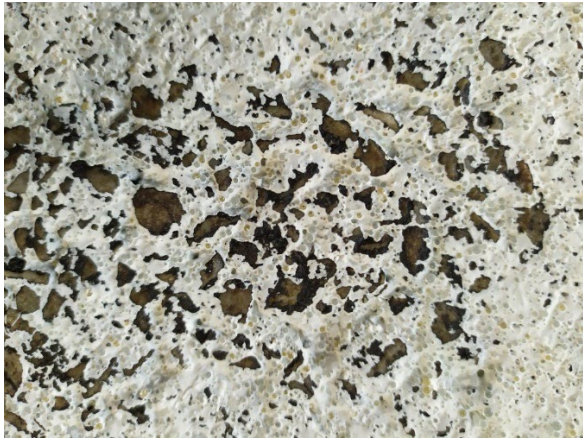
Bild 8: Beispiel für freiefahrene Gesteinskörnungen bei einer Probe auf SMA (hier: Probe W2)
