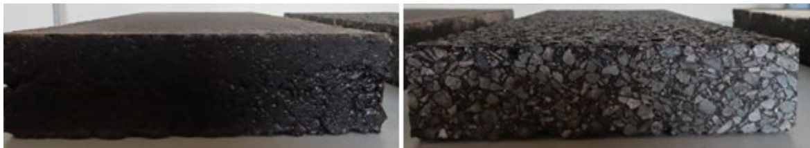
Bild 2: Ansicht der Seitenfläche eines Prüfkörpers aus Gussasphalt (links) und der Schnittkante eines Prüfkörpers aus Splittmastixasphalt (rechts)
