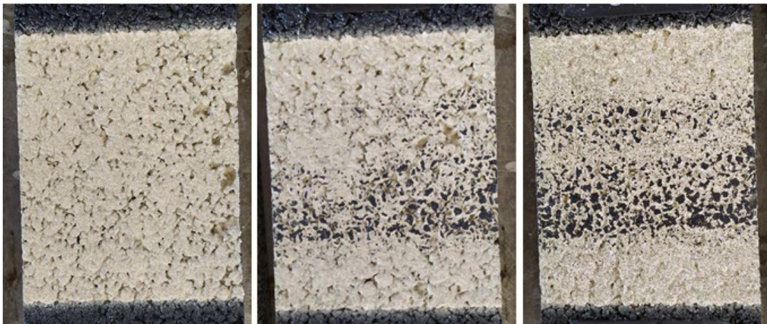
Bild 26: Beispiele für das Durchbluten (von Links nach Rechts: Probe S2 Rückstellmuster 1x300 µm, Probe S2 nach RPA 1x300 µm und Probe S4 nach RPA)
