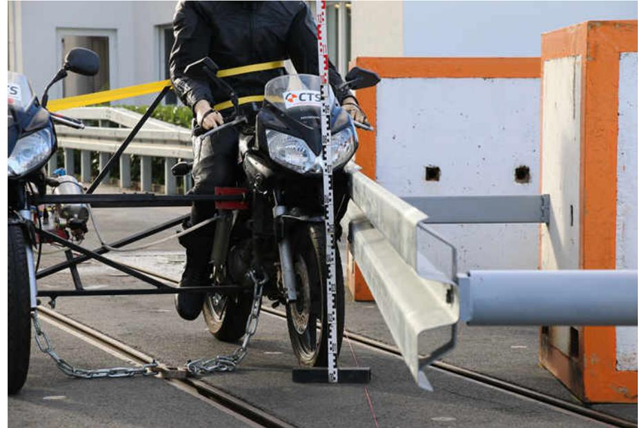
Bild 206: Anprallsituation Versuch 1a (vorne)
