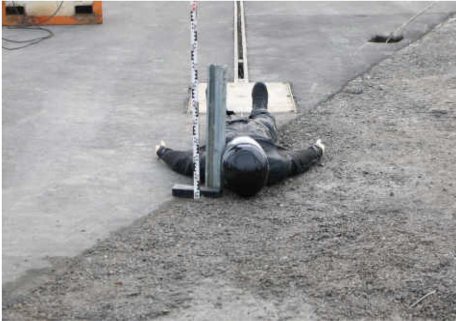
Bild 219: SOLL-Anprallsituation Versuch 3b
