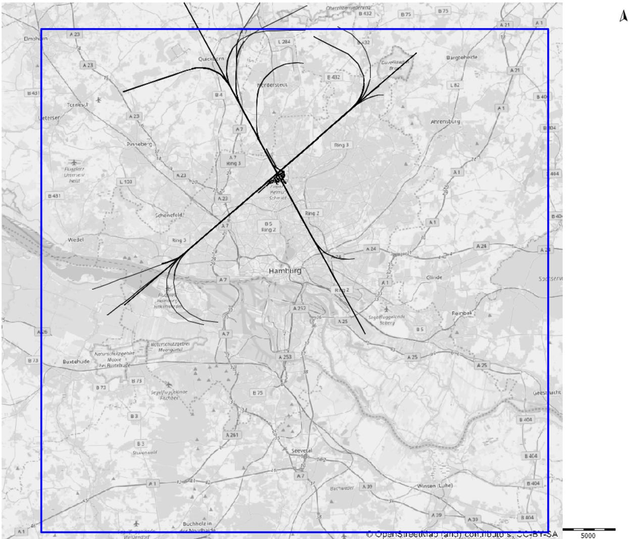
Abbildung 4-6: Lage der Emissionsquellen des Flughafens Hamburg bis zu einer Flughöhe von 915 m (schwarze Linien). Blau umrandet ist das innere Rechengebiet von EURAD.
