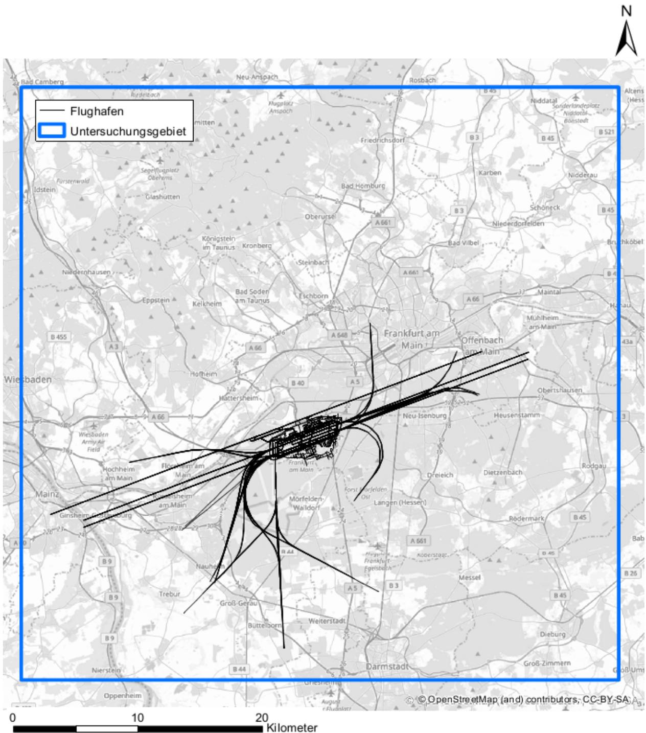
Abbildung 6-8 Lage der Emissionsquellen im Bereich Flughafen FF/M bis zu einer Flughöhe von 915 m (schwarze Linien). Blau umrandet ist das innere Rechengebiet von EURAD.
