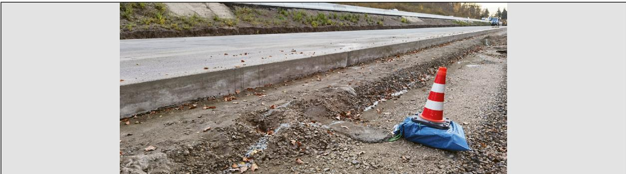
Bild 11: Messstation mit neben der Fahrbahn liegendem Reifecomputer (Quelle: TPA)
