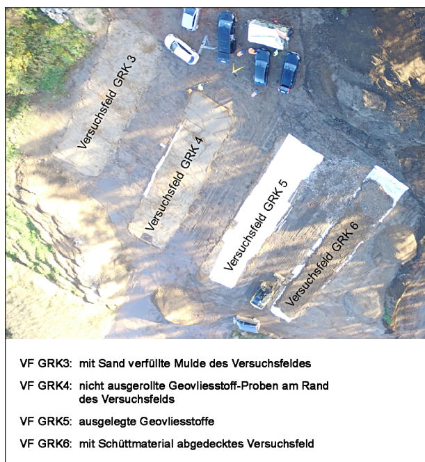
Bild 5-3: Anordnung der Versuchsfelder für die Baustellenversuche als Momentaufnahme
