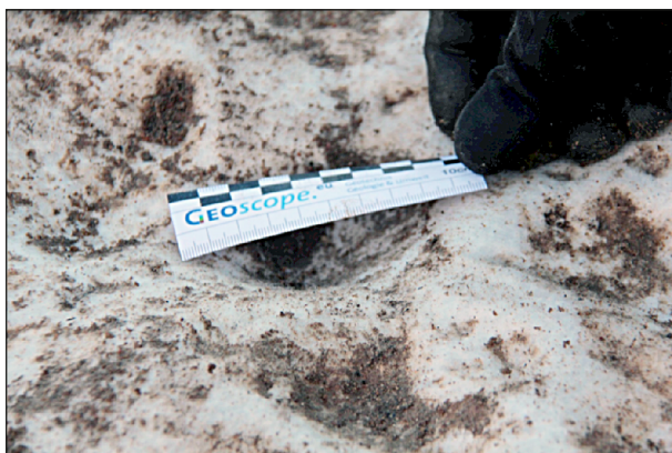
Bild 6-36: Steineindruck in einem hoch dehnfähigen Geovliesstoff auf weichem Untergrund
