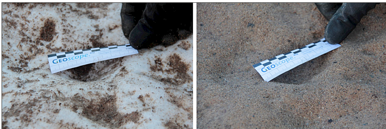
Bild 5-7: Korrespondierende Verformungen in Geovliesstoff und Untergrund
