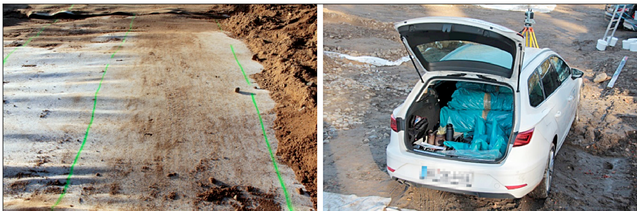
Bild 5-9: Einteilung der Probestücke und Transport der aufgerollten Probestücke
