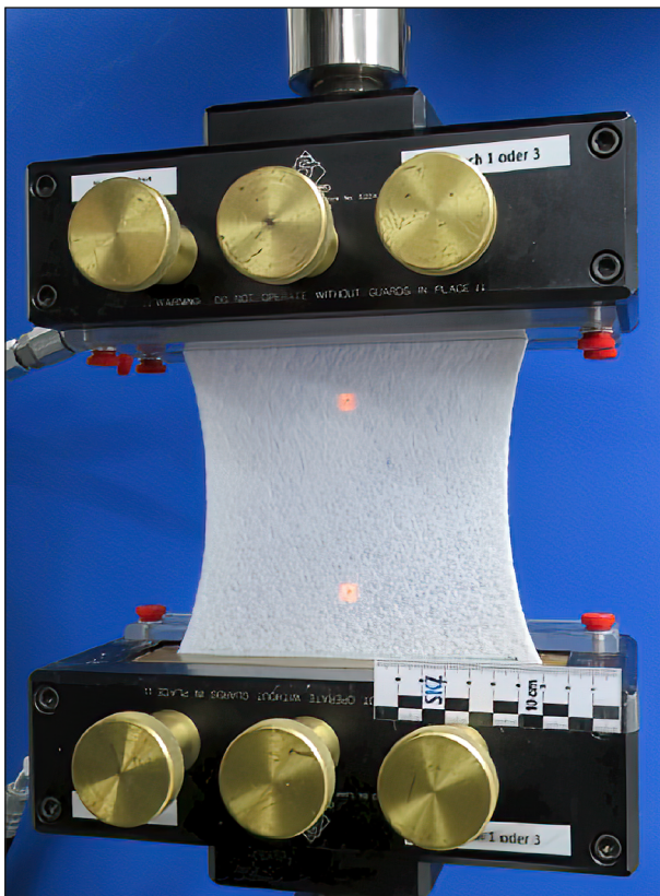
Bild 5-14: Zugversuch am Beispiel von ME-275 (Zwei rote Punkte auf der Messprobe zeigen die Messmarken zur optischen Dehnungsmessung)
