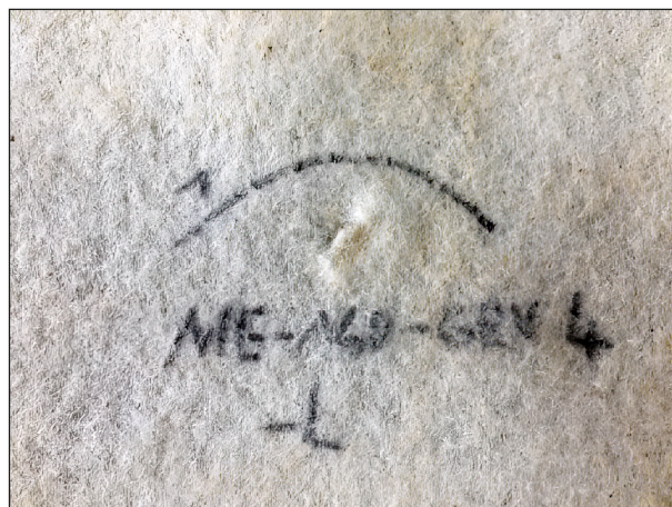
Bild 6-34: Beispiel einer Probe (ME-160-GRK4) mit einem Schädigungsgrad von 20 %
