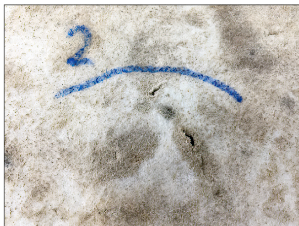
Bild 6-35: Beispiel einer Probe (ME-330-GRK5) mit einem Schädigungsgrad von 50 %
