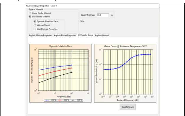
Bild 47: Berechnung der Master-Curve in 3D-Move
