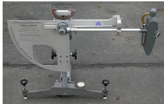
Abbildung 29: SRT-Gerät
