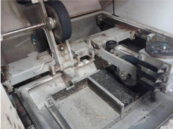
Abbildung 25: Prüfvorrichtung für Spurbildungsversuche
