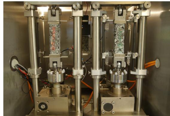
Abbildung 13: Prüfvorrichtung mit eingebauten Probekörpern für Abkühl- bzw. Zugversuche
