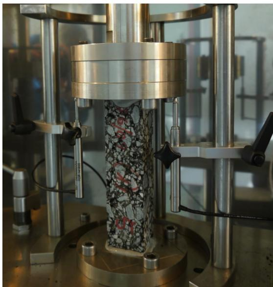
Abbildung 20: Prüfvorrichtung mit eingebautem Probekörper für Zug-Schwellversuch
