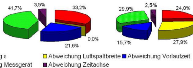
Abbildung 6: Modellgleichung, Messergebnis und Unsicherheits-Budget für die Modellbeispiele: Sende-Empfänger-Abstand 100 mm, Winkelabweichung 45°, Betondeckung 50 mm, Abstand der Antenne von der Betonoberfläche 0 bzw. 10 mm [17].
