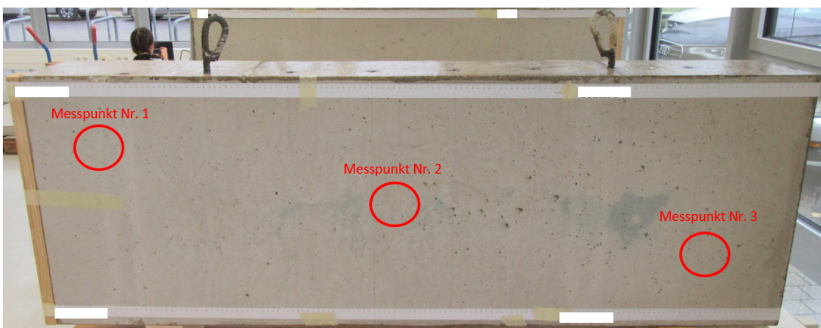
Abbildung 22: Feuchtemesspunkte an HTW-TK1
