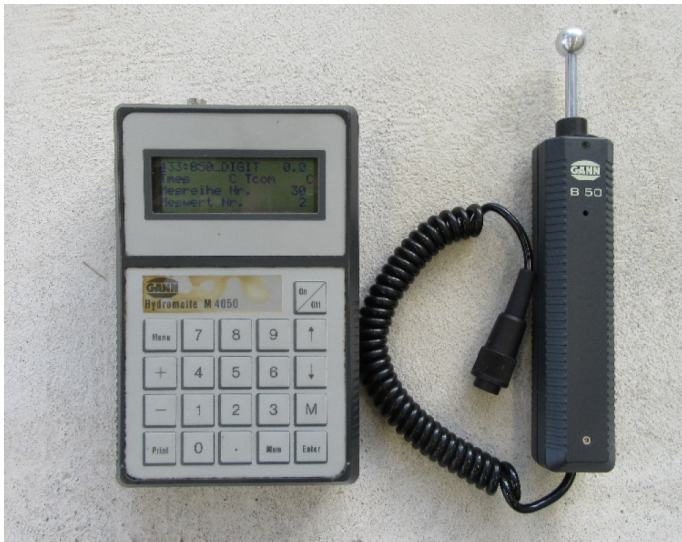
Abbildung 21: GANN Aktiv-Elektrode B 50 und Hydromette M 4050
