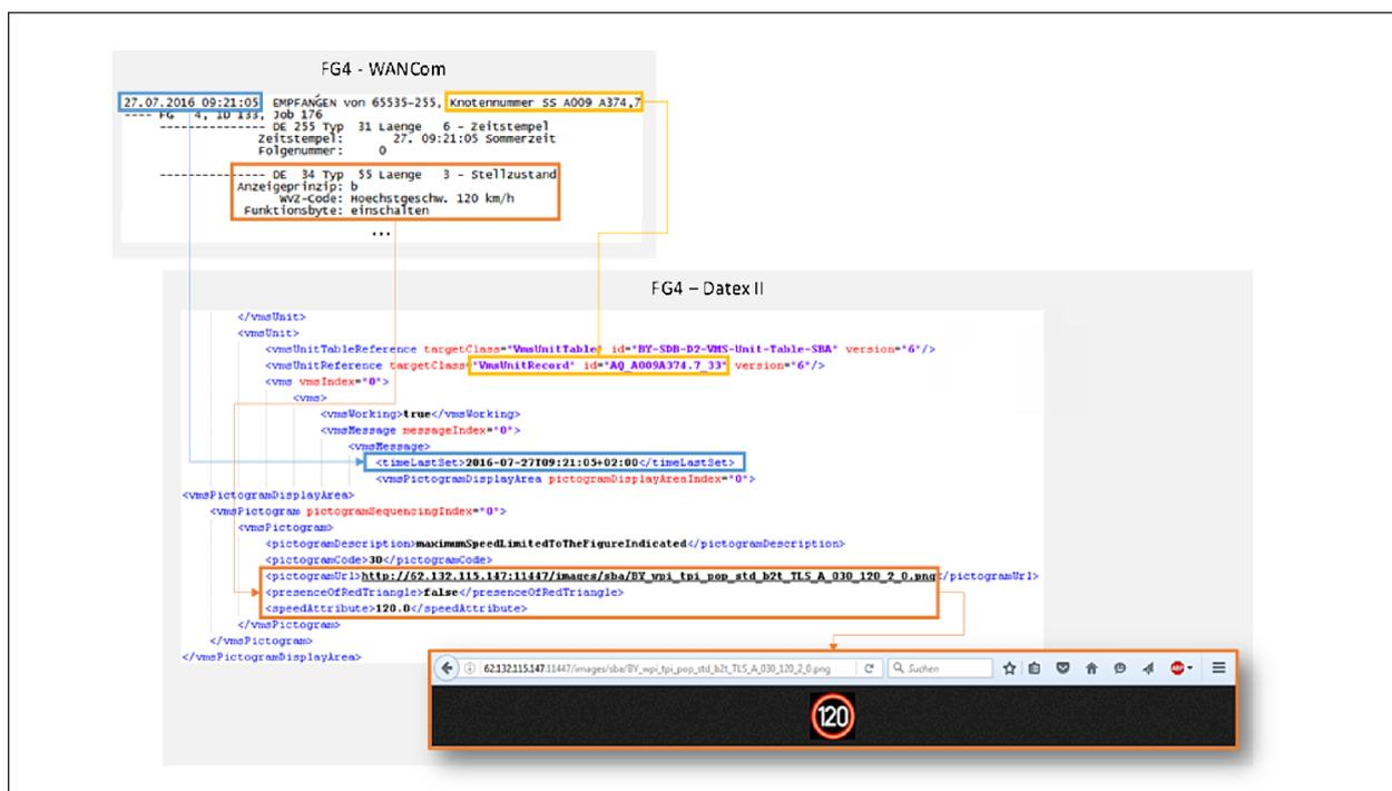
Bild 62: Abbildung von TLS-Inhalten in DATEX II, Quelle: ZVM
