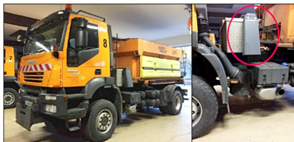
Bild 37: Mobiler Straßenzustandssensor am Streufahrzeug der AM Greding, Quelle: BASt
