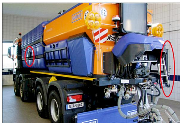
Bild 38: Streufahrzeug mit neuartigen Sensoren für die Fahrbahnzustandserkennung, Quelle: Forschung kompakt, Ausgabe 03/2020 BASt
