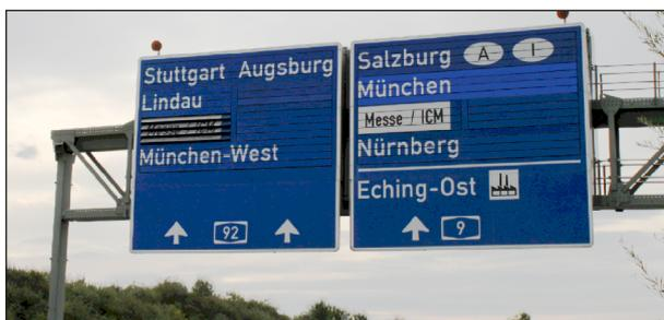
Bild 60: Wechselwegweiser beim Eindrehen eines Ziels,
