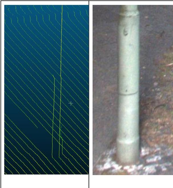
Bild 9: Der Mast einer Beleuchtungseinrichtung in der Punktwolke des CPS-Scanners (li.) und als RGB-Bild (re.).
