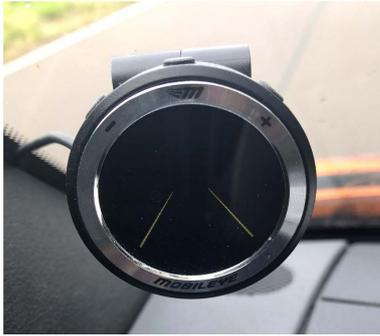
Bild 131: Kamerasystem: MOBILEYE C2-170
