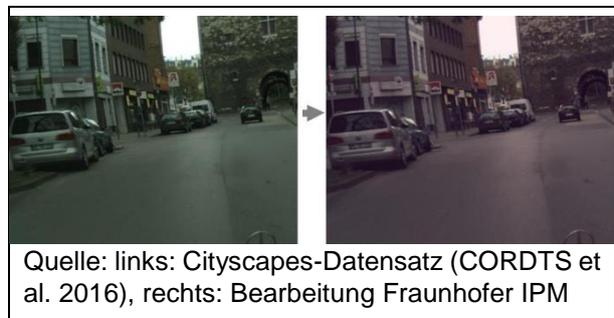
Bild 33: Mit Data Augmentation können Trainingsbilder „mehrfach“ verwendet werden, indem z.B. unterschiedliche Lichtverhältnisse bzw. Farbwerte simuliert werden.
