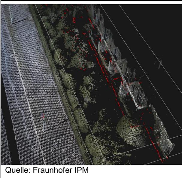
Bild 82: Die roten Punkte markieren die Projektion der konkaven Hülle des Bauwerks auf die zuvor berechnete Straßenebene (Label aus der manuellen Annotierung; Auflösung der Punktwolke auf 10 cm reduziert; Alpha-Parameter: 0,9).
