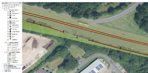
Bild 99: Luftbild DOP20 überlagert mit der Referenzdigitalisierung, BAB A4 mit Schutzwand (rot – Schutzplanke, gelbe Fläche – Fahrbahn, grün Fläche – Vegetation, beige gepunktete Linie – Schutzwand)
