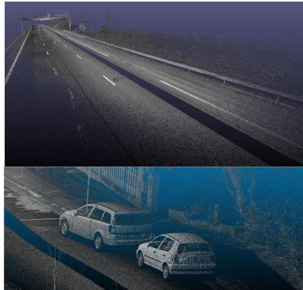
Bild 7: 3D Punktwolke des CPS Scanners mit 10° Sichtschatten der Referenzfaser zum Boden gerichtet. Die Referenzfaser dient der internen Kontrolle der Längen- und Winkelmessung pro Umdrehung des Laserscanners.
