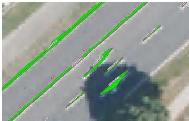
Bild 101: Extrahierte Linienobjekte (rot) aus Umring-Polygonen (grün) (Objektklasse -Fahrbahnmarkierung)
