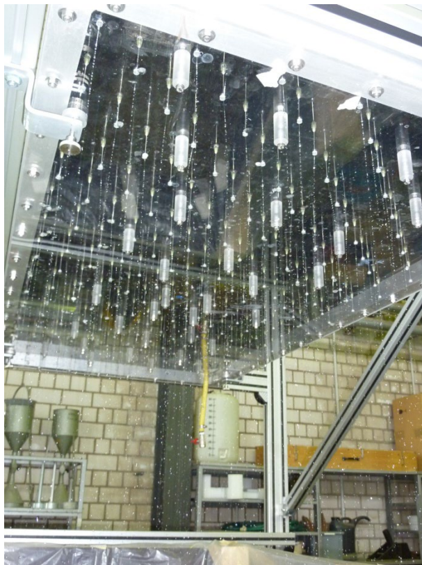
Bild 3-7: Detailaufnahme des Beregnungskopfes von unten während der Beregnung
