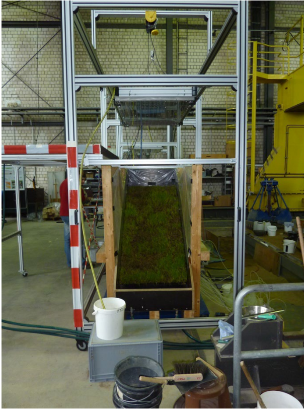
Bild 3-9: Beregnungskopf mit Gestell und offener Schublade über Lysimeterkasten (Vorderansicht)
