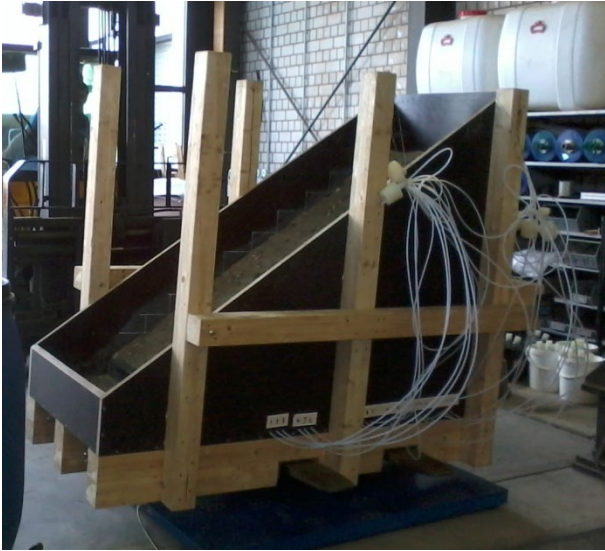
Bild 3-1: Seitenansicht des Lysimeterkastens, beim Aufstellen auf die Waage
