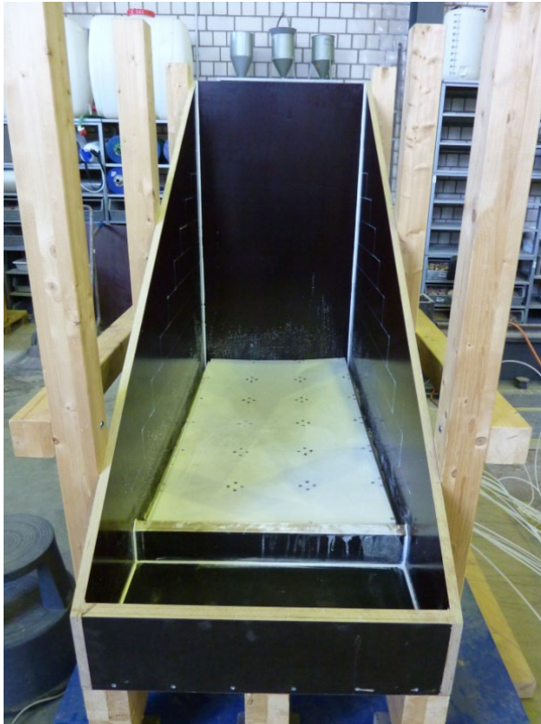
Bild 3-2: Lysimeterkasten mit Sicht auf die Saugplatten
