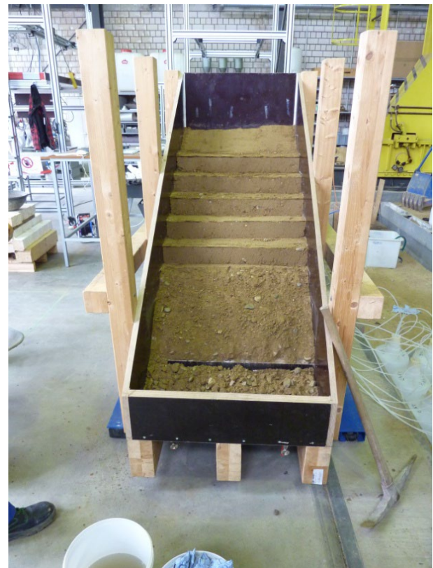
Bild 3-5: Abtragen des treppenförmigen eingebauten Materials zur Herstellung der Böschungsneigung
