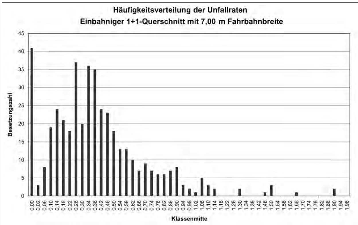
Bild 26: Histogramm-Darstellung der Unfallraten UR für einbahnige 1+1-Querschnitte mit einer Fahrbahnbreite von 7,00 m (Basis: UT 1-7, PS, SS)
