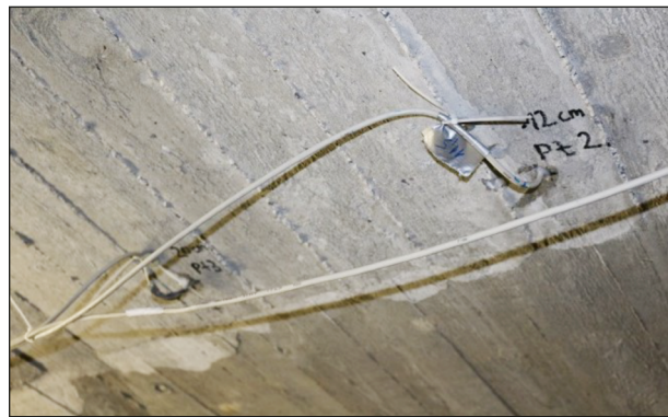
Bild 4-28: In Bohrloch eingebrachter und mit Silikon gedämmter Temperatursensor (Foto: matrices engineering GmbH)
