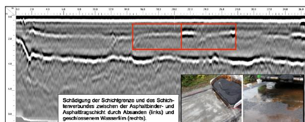
Bild 32: Visuelle Abgrenzung einer geschädigten Schichtgrenze im Radargramm zwischen den Stationen 0+015 und 0+028 in der Messlinie 2 (Display Gain = 30,  $f = 2.000$  MHz, Scanrate = 50 Scans/m)
