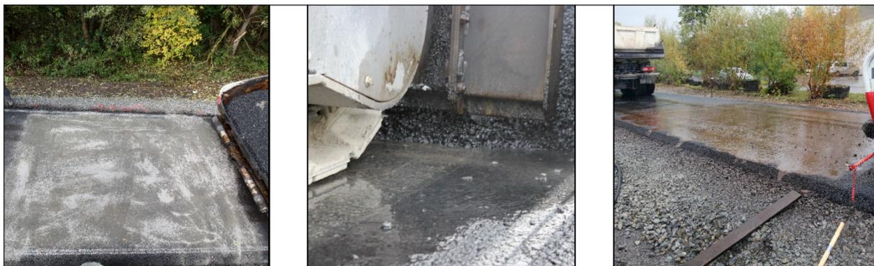
Bild 18: Künstlich erzeugte Störstellen in der Schichtgrenze durch Absanden, Wasserfilm und Überfettung
