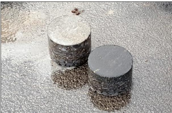
Bild 58: Bohrkern der Objektebene ohne Schichtenverbund zwischen Asphaltbinder- und Asphalttragschicht
