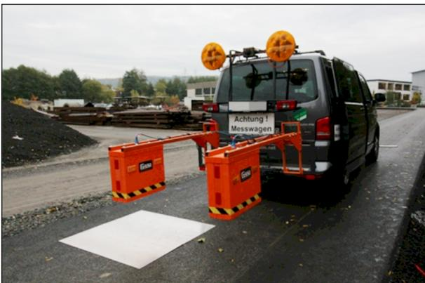
Bild 11: Erzeugung von stationären Kalibrierscans auf der Versuchsstrecke mittels Metallplatte
