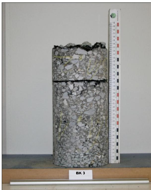
Bild 60: Bohrkern der Versuchsstrecke mit rauer und ungleichmäßiger Unterseite
