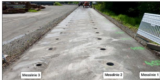
Bild 24: Anordnung des Stationierungsrasters der Bohrkern in den Messlinien des Georadars auf der Objektebene
