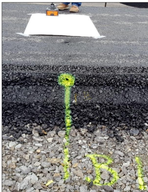
Bild 21: Detektion eines künstlich erzeugten Hohlraums in der Asphaltbinderschicht
