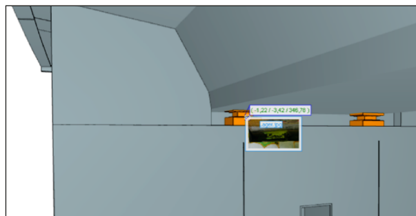
Bild 29: Verknüpfung einer Bildaufnahme am 3D-Modell und Schadensposition
