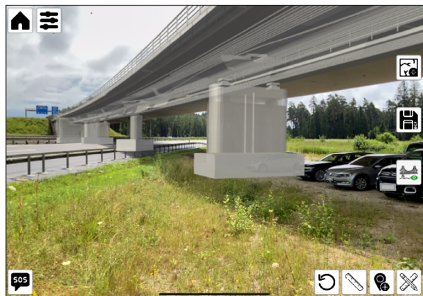
Bild 106: Halbtransparente Modellüberlagerung vor Ort. Sichtbar ebenfalls das zur Evaluation angepasste User Interface.
