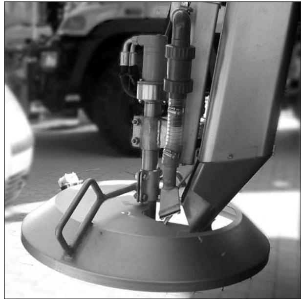
**Bild 3:** Beispiel eines Streustoffverteilers
