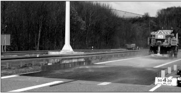
**Bild 26:** Verwirbelung der Tausalze beim Ausbringen mit hoher Fahrgeschwindigkeit (hier 50 km/h mit FS5-Anfeuchtung)
