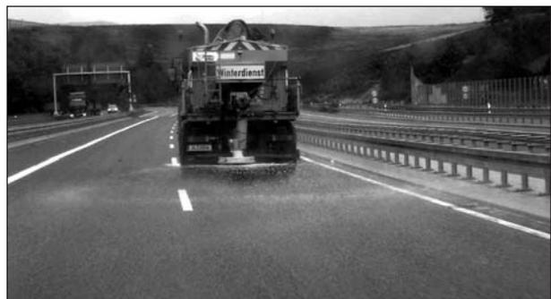
**Bild 10:** Ausbringen von Tausalzen mit einer Streubreiteneinstellung von 8 m bei ca. 60 km/h, FS30-Streuer (gleiche Fahrt mit gleicher Einstellung wie bei Bild 9)
