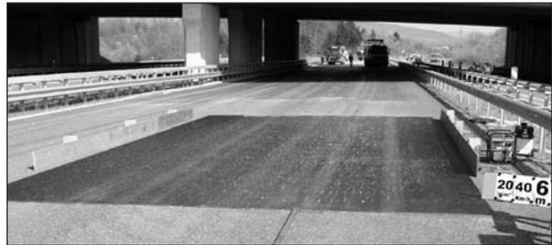
**Bild 15:** Beurteilung von Streubildern auf Gummimatten – Aufbau der Prüffläche für 6 m Sollstreubreite
