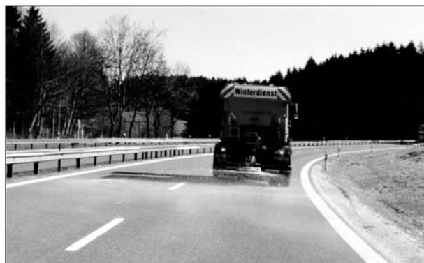
Bild 4: Beurteilung einer Feuchtsalzstreuung bei der Hinterherfahrt
