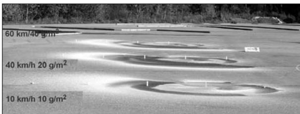
**Bild 29:** Ausbringung von Steinsalz, Körnung 0-3, im Stand bei verschiedenen simulierten Streugeschwindigkeiten, Einstellungen: 20 g/m<sup>2</sup> Streudichte, 8 m Streubreite, 6 m nach links, 2 m nach rechts von Fahrzeugmitte, trockene Witterung
