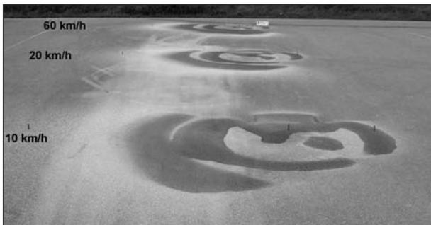
**Bild 20:** Im Stand ausgebrachte Streubilder mit 8 m Streubreite, asymmetrisch ca. 2 m nach rechts und 6 m nach links, Streudichte: 20 g/m<sup>2</sup>, FS30-Anfeuchtung
