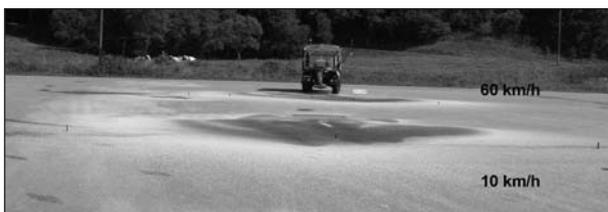
**Bild 22:** Im Stand ausgebrachte Streubilder mit 12 m Streubreite, symmetrisch, Streudichte: 10 g/m<sup>2</sup>, FS30-Anfeuchtung
