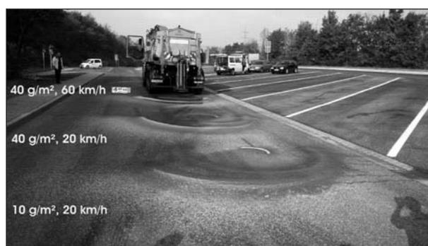
**Bild 17:** Im Stand ausgebrachte Streubilder mit 4 m Streubreite, symmetrisch, FS30-Anfeuchtung
