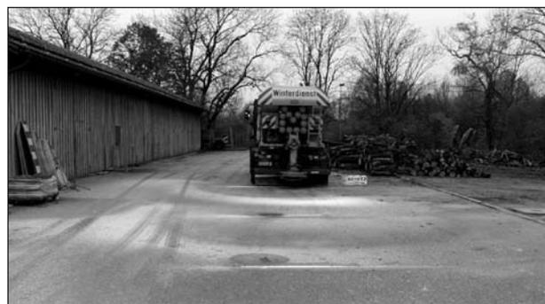
**Bild 24:** Zwei Streubilder im Stand ausgebracht vor und nach der Verstellung der Position eines Rutschbleches (siehe Bild 23) ohne Verstellung sonstiger Parameter am Bedienpult (10 g/m<sup>2</sup> Streudichte, 12 m Streubreite, symmetrisch, 60 km/h simulierte Streugeschwindigkeit)
