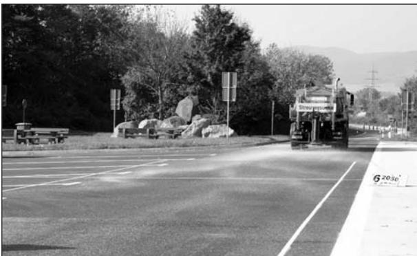
**Bild 33:** Ausbringen der Streustoffe auf einer geeigneten Fahrbahn (Einstellungen: 20 g/m<sup>2</sup> Streudichte, 6 m Streubreite, Streustreifenlage 2 m nach rechts und 4 m nach links, Fahrgeschwindigkeit: 50 km/h)
