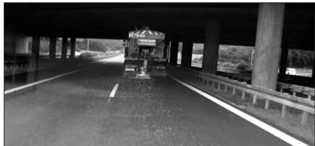
**Bild 9:** Ausbringen von Tausalzen mit einer Streubreiteneinstellung von 8 m bei ca. 30 km/h, FS30-Streuer
