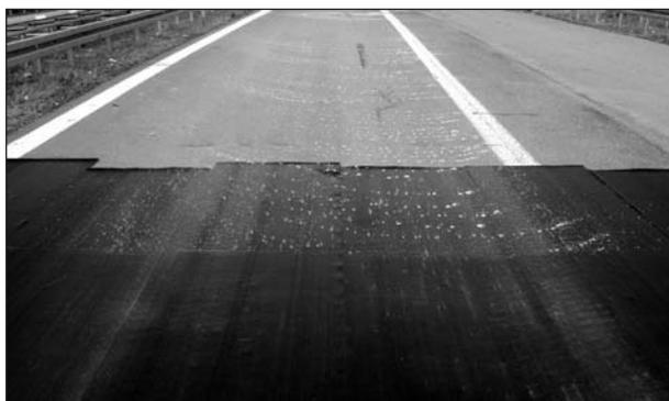
**Bild 16:** Gummimatten mit abgesaugten und nicht abgesaugten Flächen sowie asphaltierter Anschlussbereich (Ausbringung von 20 g/m<sup>2</sup> mit 4 m eingestellter Streubreite bei 20 km/h)
