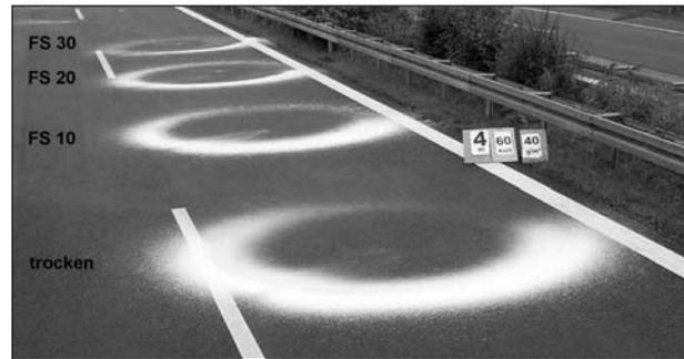
**Bild 27:** Im Stand ausgebrachte Streubilder mit unterschiedlichen Verhältnissen Trockenstoff:Lösung (Streudichte 40 g/m<sup>2</sup>, Streubreite 4 m, simulierte Streugeschwindigkeit 60 km/h, gleiche Ausbringmengen)
