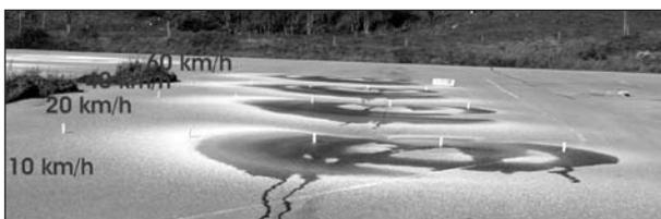
**Bild 30:** Ausbringung von Steinsalz, Körnung 0-5, im Stand bei verschiedenen simulierten Streugeschwindigkeiten, Einstellungen: 20 g/m<sup>2</sup> Streudichte, 8 m Streubreite, 6 m nach links, 2 m nach rechts von Fahrzeugmitte, trockene Witterung
