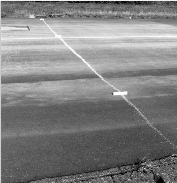
**Bild 6:** Tausalz, zusammengekehrt längs der Fahrtrichtung, auf Asphalt, über 10 m Länge, Streudichte: 20 g/m<sup>2</sup>, Fahrgeschwindigkeit nicht simuliert
