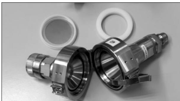
Bild 3-8: Filterblättchen und Filterhalter zur Montage in die CVS-Anlage
