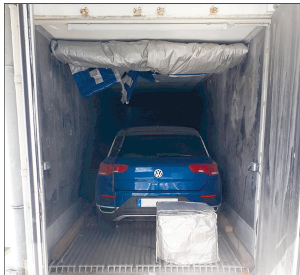
Bild 6-1: Prüffahrzeug D im Kühlcontainer für die Kaltstarts bei -15 °C
