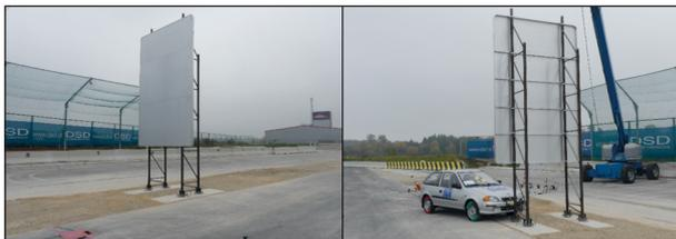
Bild 3-3: Anpralltest Gabelständer 750 x 76 mm bei ca. 35 km/h vor dem Versuch
