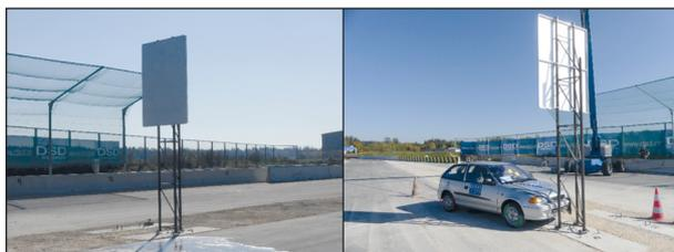
Bild 3-7: Anprallsituation Trimast 500 x 60 mm bei 100 km/h vor dem Versuch
