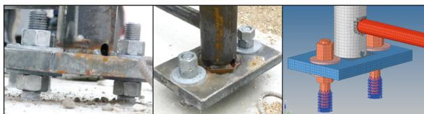
Bild 2-17: Detaillierte Ansicht der Fußplatte. Die Fixierung der Gesamtkonstruktion erfolgt in der Simulation über das Einspannen von Elementknoten (blaue Dreiecke). Die Schweißnahtverbindung wird mittels fixierten Elementverbindungen (dunkelgraue Struktur) umgesetzt. Die Versuche wurden mit zwei Schraubmuttern über der Fußplatte durchgeführt, die im Modell durch eine durchgehende Schraubmutter angenähert wurden.
