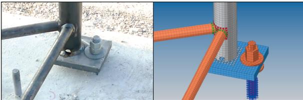
Bild 2-21: Vergleich von Versuch und Modell im unteren Mastbereich des vorderen Gurtrohres mit Fußplatte. Die Schweißnähte (rote, grüne und graue Struktur) wurden dem Realmast angepasst. Die Gewindestangen wurden durch fixierte Elementknoten befestigt (blaue Struktur).
