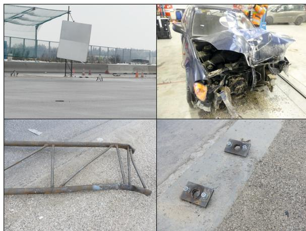
Bild 3-2: Anprallsituation am Gabelständer 750 x 76 mm bei 100 km/h nach dem Versuch
