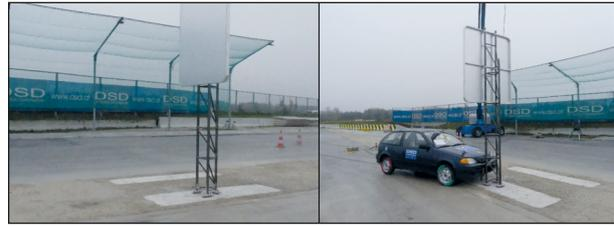
Bild 3-11: Anprallsituation Trimast 350 x 48 mm bei 35 km/h vor dem Versuch
