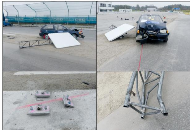
Bild 3-12: Anprallsituation Trimast 350 x 48 mm bei 35 km/h nach dem Versuch
