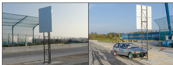
Bild 3-9: Anprallsituation Trimast 500 x 60 mm bei 35 km/h vor dem Versuch
