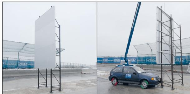
Bild 3-1: Anpralltest Gabelständer 750 x 76 mm bei 100 km/h vor dem Versuch
