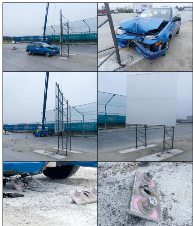
Bild 3-6: Anprallsituation am Gabelständer 750 x 60 mm bei 35 km/h nach dem Versuch
