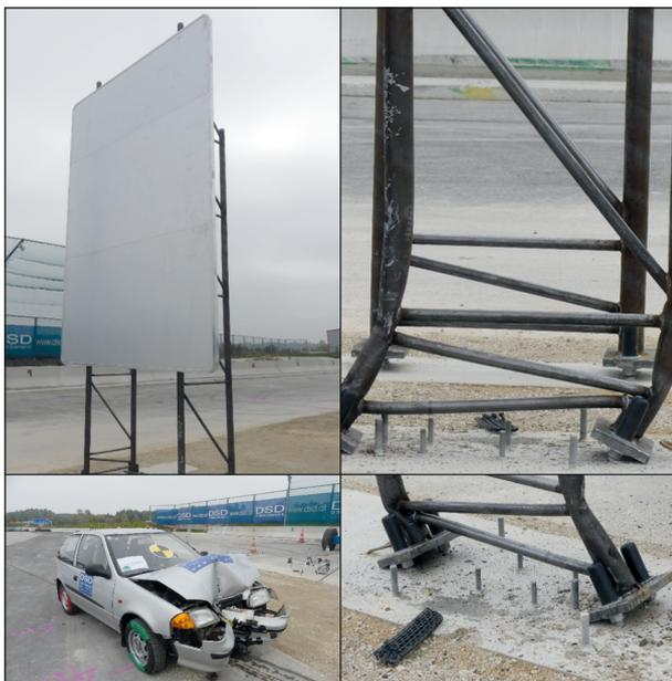
Bild 3-4: Anprallsituation am Gabelständer bei ca. 35 km/h nach dem Versuch
