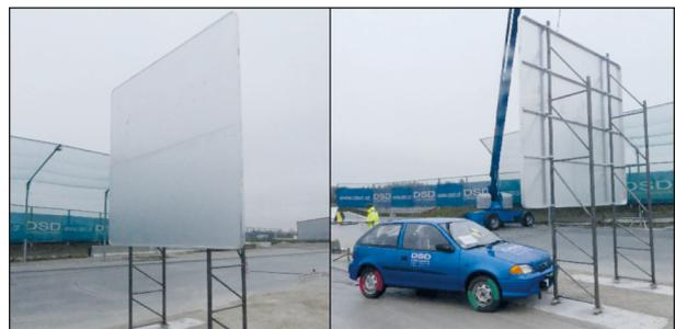
Bild 3-5: Anprallsituation am Gabelständer 750 x 60 mm bei 35 km/h vor dem Versuch
