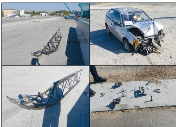
Bild 3-8: Anprallsituation Trimast 500 x 60 mm bei 100 km/h nach dem Versuch
