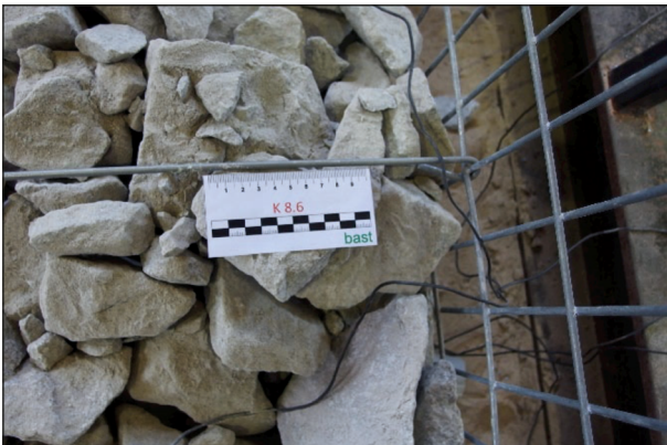
Bild 5-12: Distanzhalterhaken an der Rückseite von K8.6 ist geschlossen.
