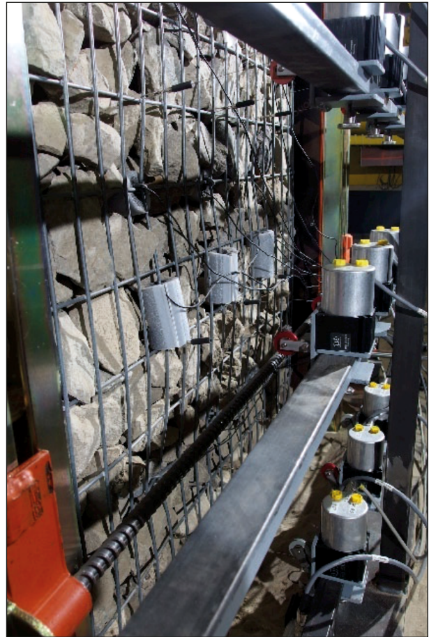
Bild 4-7: Ausbauchung des Frontgitters zwischen den Ebenen der Distanzhalter (0,3 m und 0,7 m) während Versuch 3.
