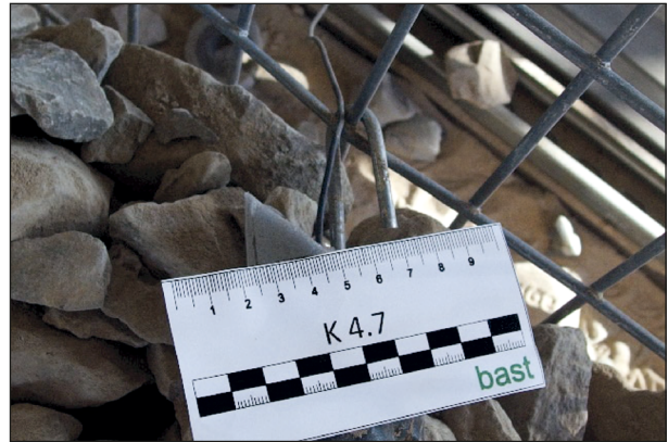
Bild 4-12: Aufgebogener Distanzhalterhaken 4.7 an der Frontseite der Gabione nach Versuchsende
