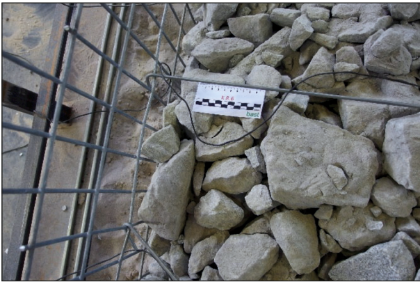
Bild 5-11: Distanzhalterhaken von K8.6 an der Frontseite ist komplett aufgebogen.
