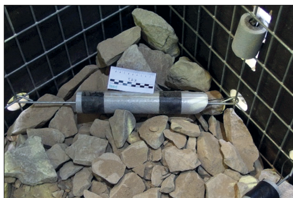
Bild 4-2: Schutz der Kabel der Kraftsensoren in den Distanzhaltern
