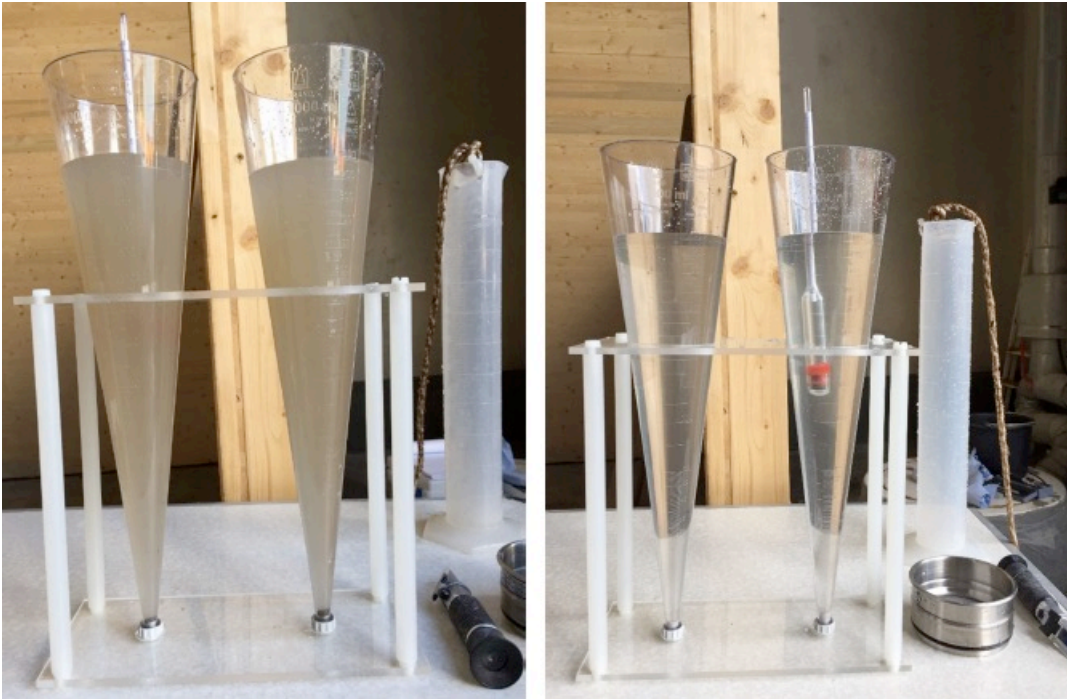
Bild 41: Sedimentiergefäße nach Imhoff mit eingefüllter Sole (links: sedimentierter Salzton, rechts: sedimentiertes Calciumsulfat)
