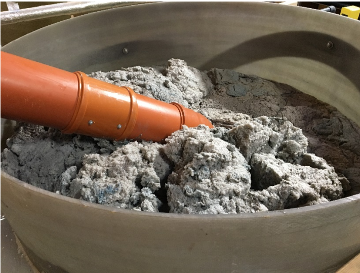
Bild 48: Schaumbildung bei der Soleproduktion mit Steinsalz F aus Sondershausen in der AM Kaisersesch
