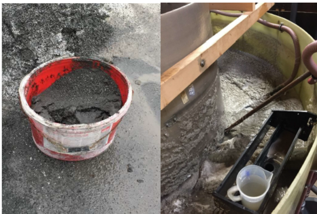
Bild 43: Löserückstand aus der Soleproduktion mit Steinsalz M aus Heilbronn in der AM Kist (links) und mit Steinsalz F aus Sondershausen in der AM Kaisersesch (rechts)
