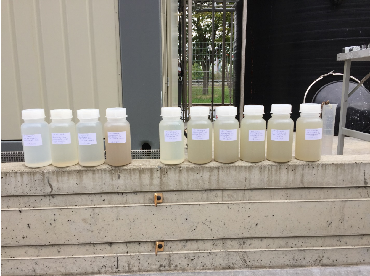
Bild 52: Proben von frisch produzierter gebrauchsfertiger Sole aus der SM Neumarkt und aus der AM Erlangen (von links nach rechts: SM Neumarkt (NM)-Soletank, NM-Siedesalz EF Ebensee, NM-Steinsalz M Bernburg, NM-Steinsalz EF Heilbronn, AM Erlangen (ERL)-Soletank, alle weiteren Proben ERL-Steinsalz M Heilbronn)
